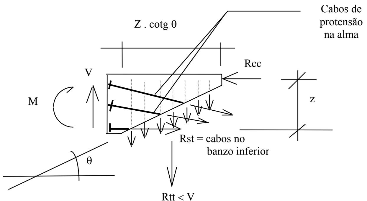
É um hábito calcular apenas o efeito da componente transversal da força do cabo , descontando essa componente da força cortante atuante .
