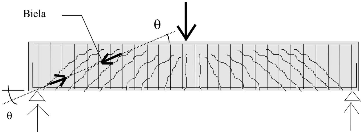
O ângulo da biela equivalente não coincide com o ângulo da fissura
