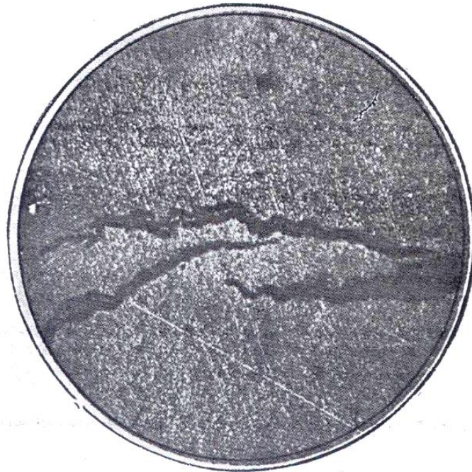
Microfotografia interessando um conjunto de fissuras de "stress- corrosion" ainda em arame do acidente do km 47. Ataque: nital. x 95
