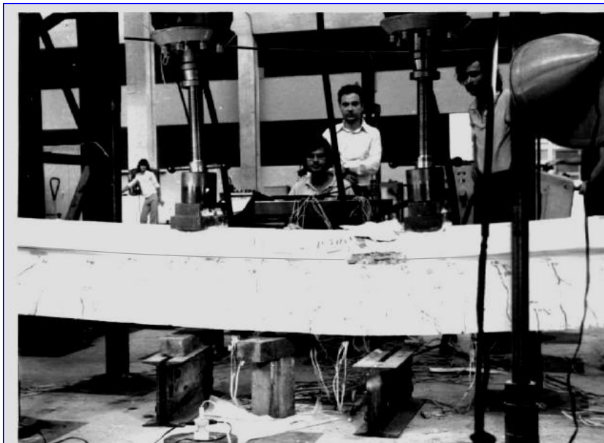
Foto 24 - Ruptura da viga VNB/50 P_u = 52 \text{ kN} Neste caso não houve esmagamento to tal da seção por ter sido a força inicial de protensão relativamente baixa,
