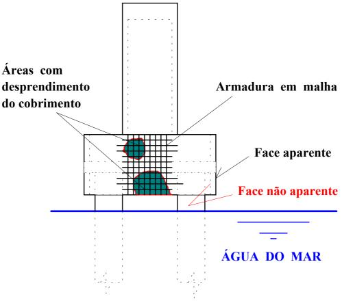
Cobrimento deficiente : 3cm na face visível da saia premoldada 1cm na face invisível da saia premoldada
