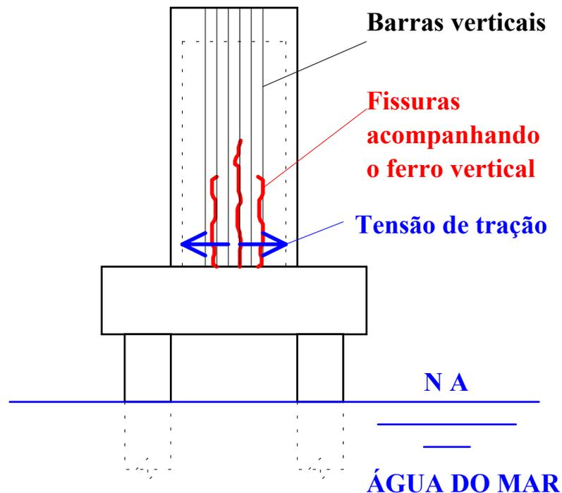
**CAUSA DA FISSURAÇÃO:** Próximo à base do pilar , até a uma altura aproximadamente igual à largura do pilar, existem tensões de tração na direção horizontal do pilar devidas a :
