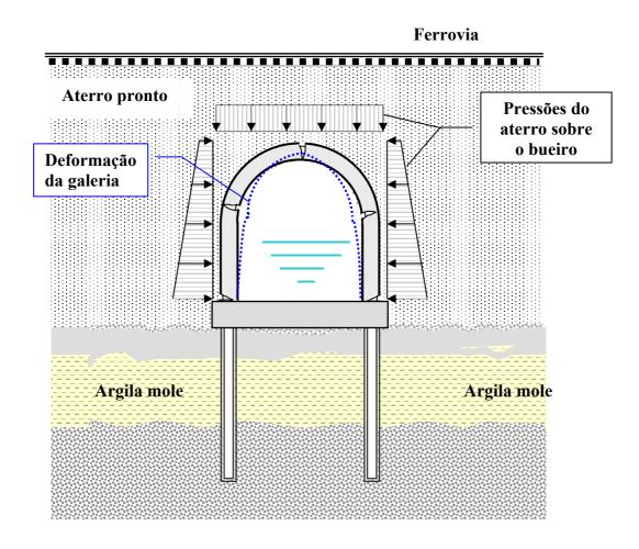
CAUSAS: Espessura pequena das paredes do bueiro. Armadura pequena nas paredes do bueiro.
