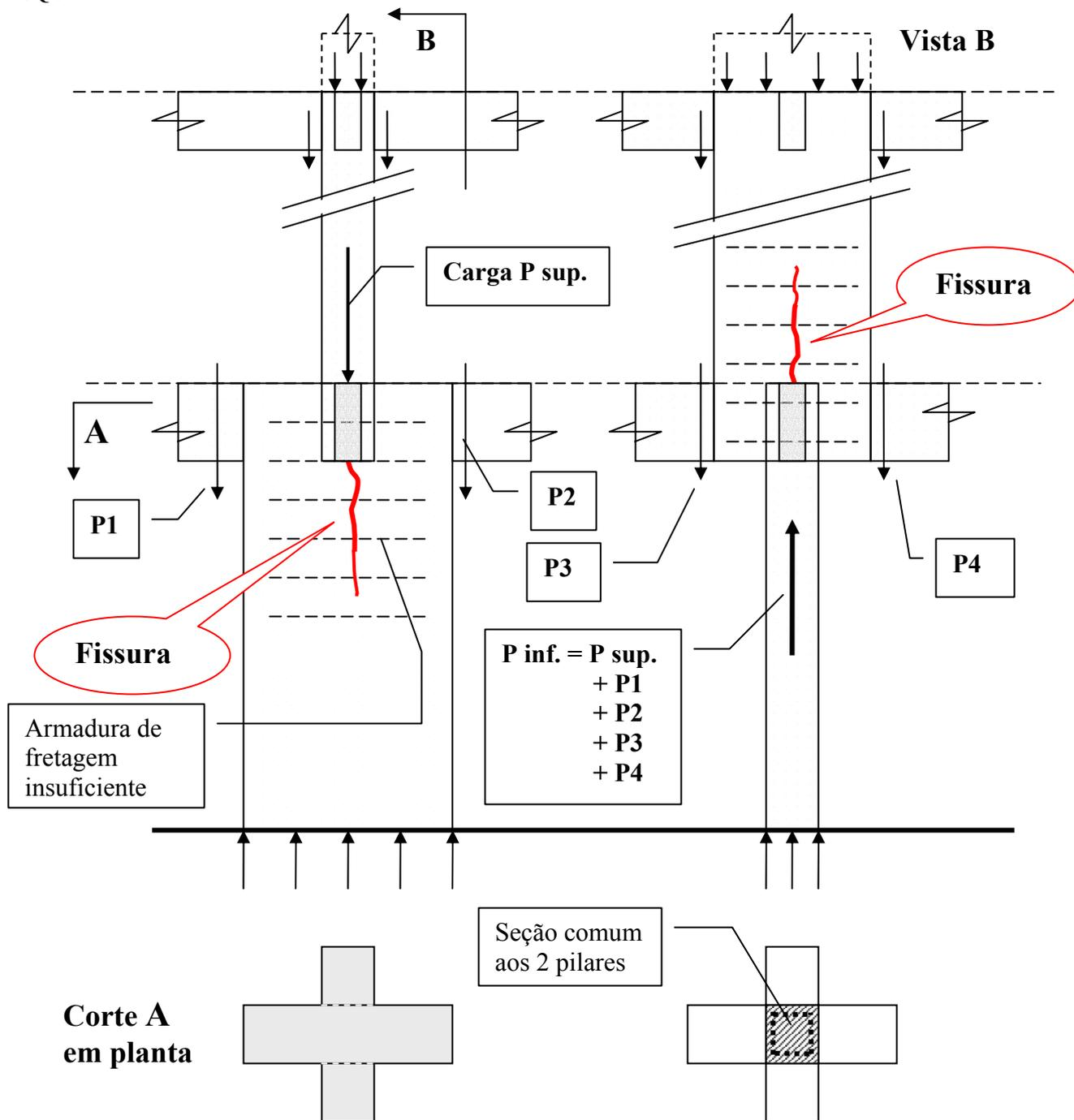
**CAUSA DA FISSURAÇÃO :** Fendilhamento devido à atuação da carga de um pilar estreito em um pilar largo. A armadura de fretagem era insuficiente. Ver a figura da próxima página, reproduzida de Fritz Leonhardt [4], vol. 2.
