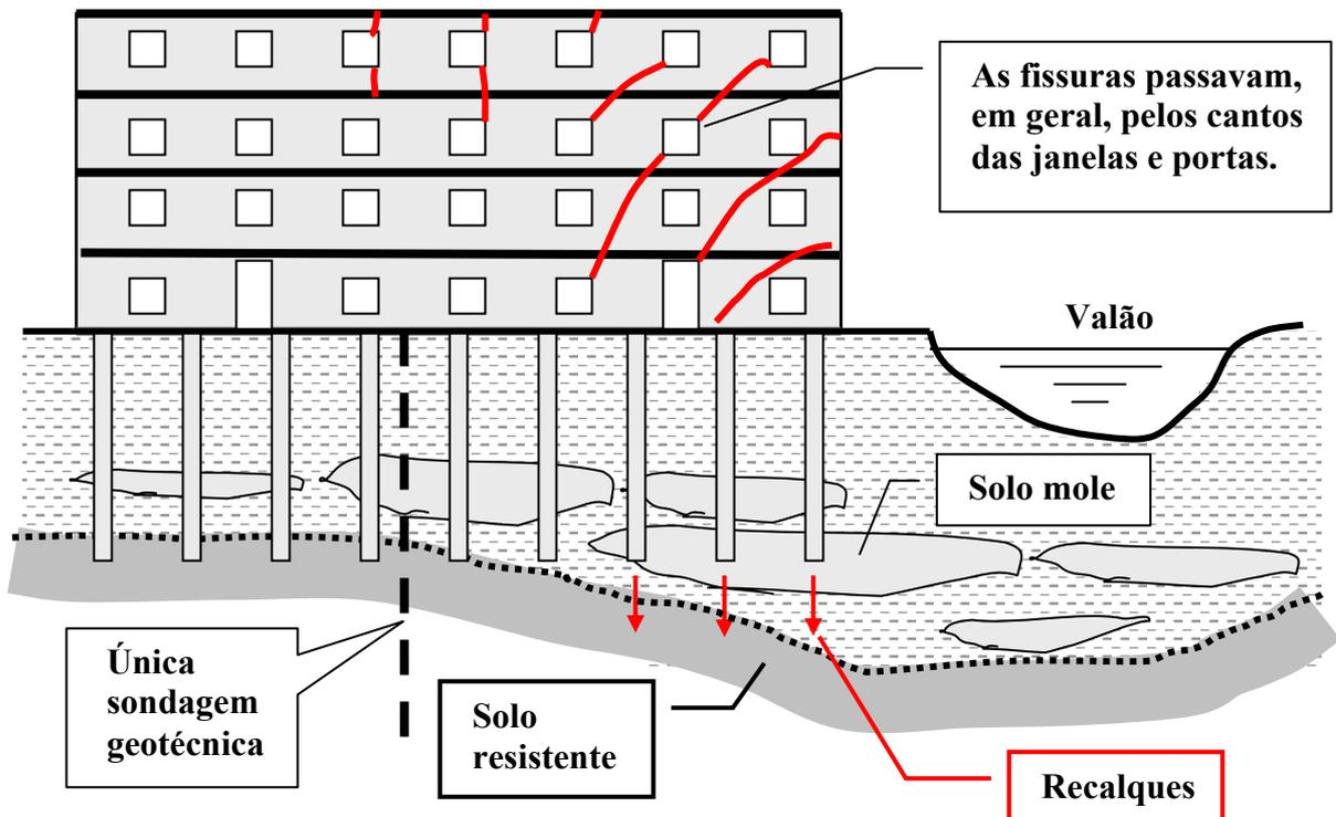
**CAUSA DA FISSURAÇÃO :** O comprimento insuficiente de várias estacas .
