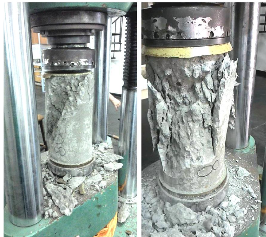
Figura 4 – Corpo de prova após a ruptura
