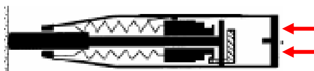
Operador comprime o esclerômetro e traciona a mola
