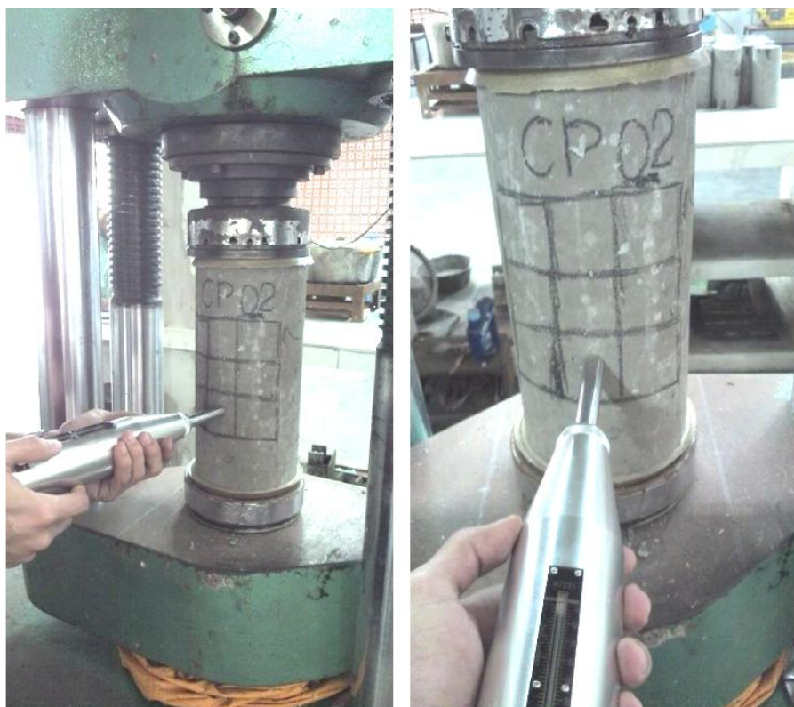
Figura 3 – Ensaio esclerométrico na superfície do corpo de prova
