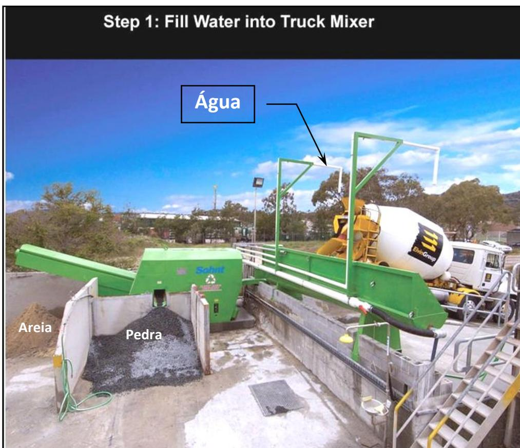
Colocar água nos caminhões betoneiras com restos de concreto.
