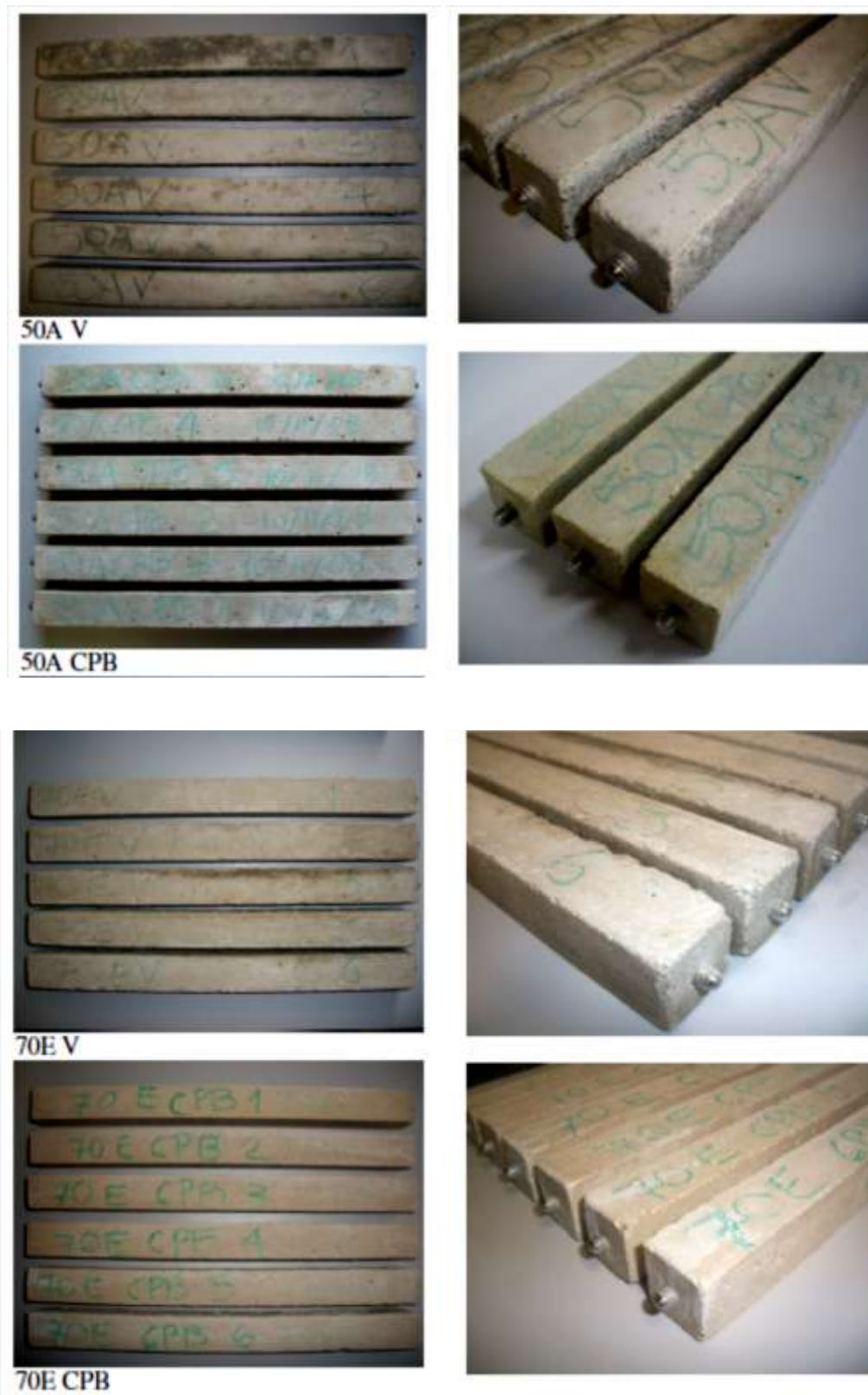
Figura 51 – Fotografias das barras imersas em solução de sulfato por 24 meses.
