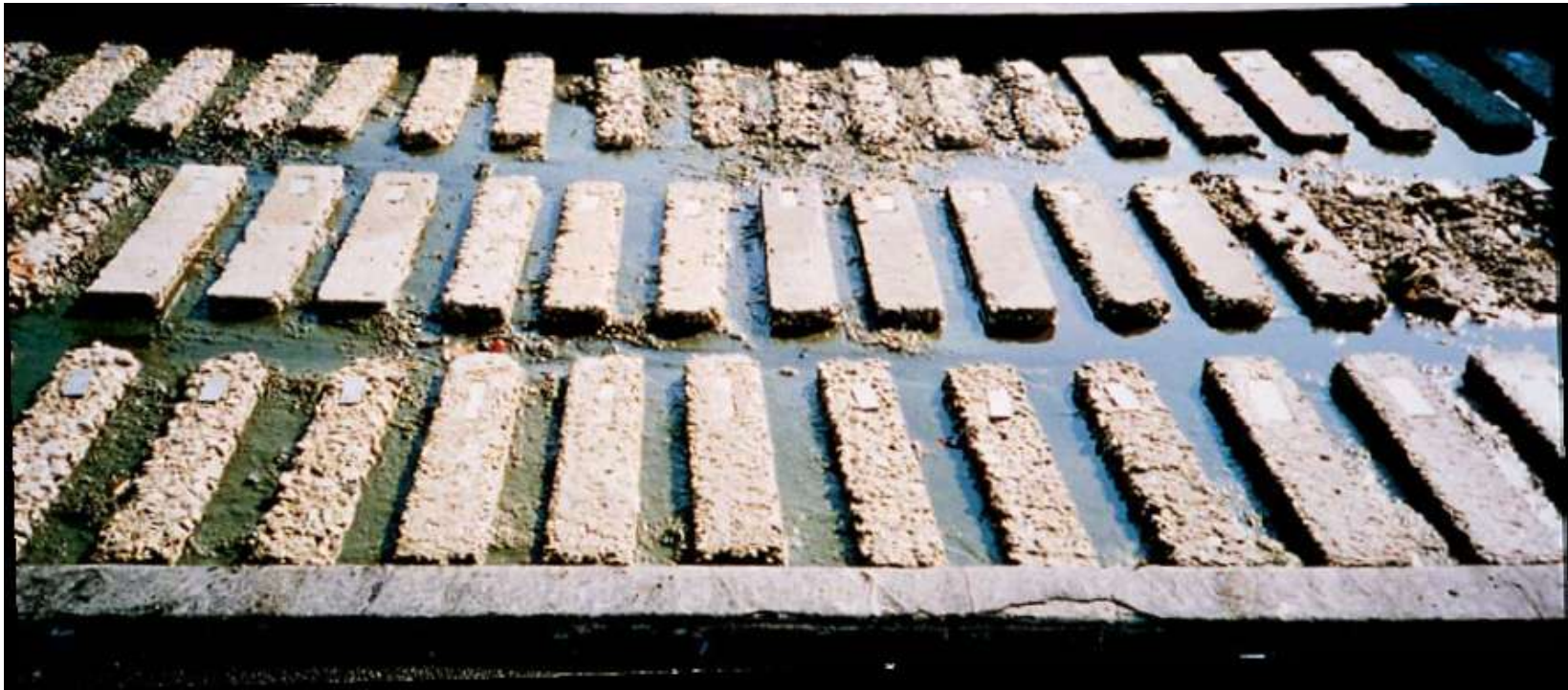
Fig. 1 - Substâncias agressivas podem comprometer a durabilidade do concreto. Na foto as vigas de concreto expostas a soluções contendo alto teor de sulfatos. Instalações de teste PCA / CALTRANS em Sacramento / Califórnia / USA ( David Stark 2002 )
