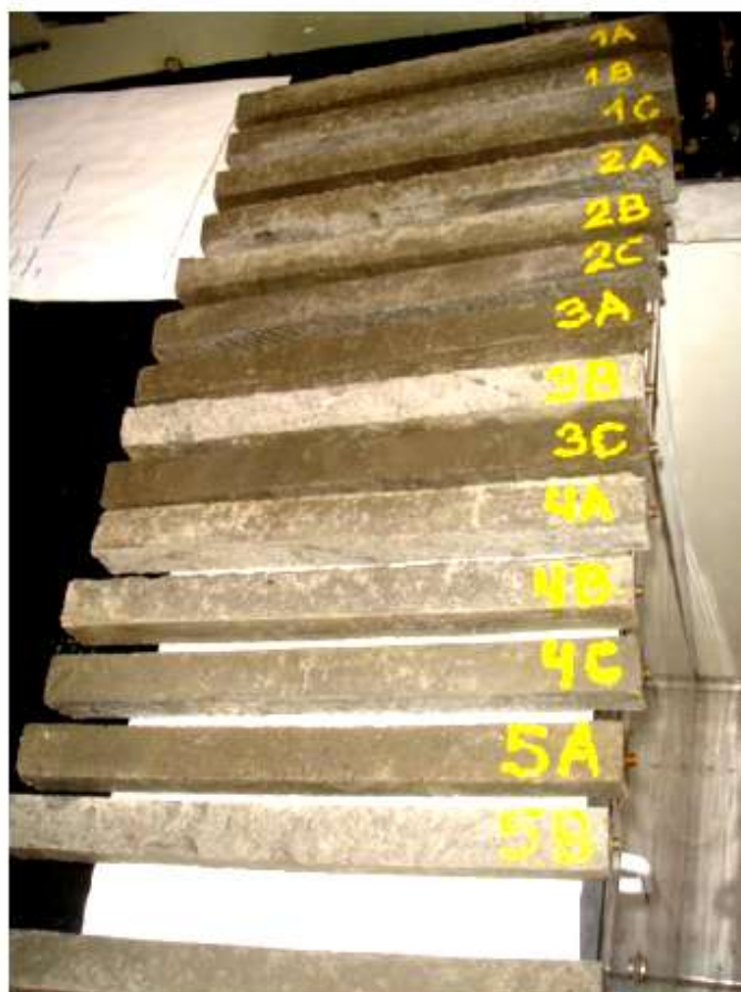
Figura 31: Corpos-de-prova retirados dos moldes
