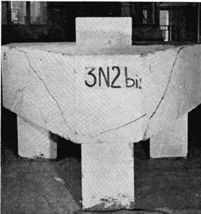
3 N 2 bis. Vue générale de la fissuration à rupture.
