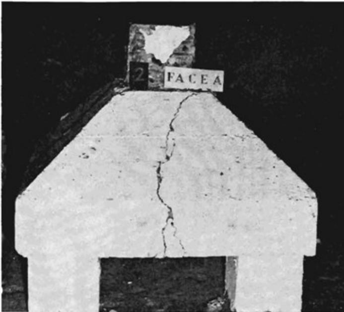
2,3. Fissure de rupture d'allure verticale.
