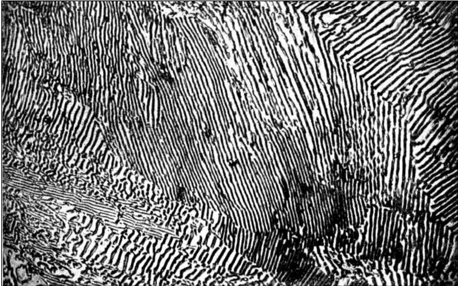
1971 - Aspecto de um aço eutetóide esfriado lentamente.- PERLITA = Cementita em preto e a Ferrita em branco - O espaçamento inter-lamelar é de 0,30 micrometros.
