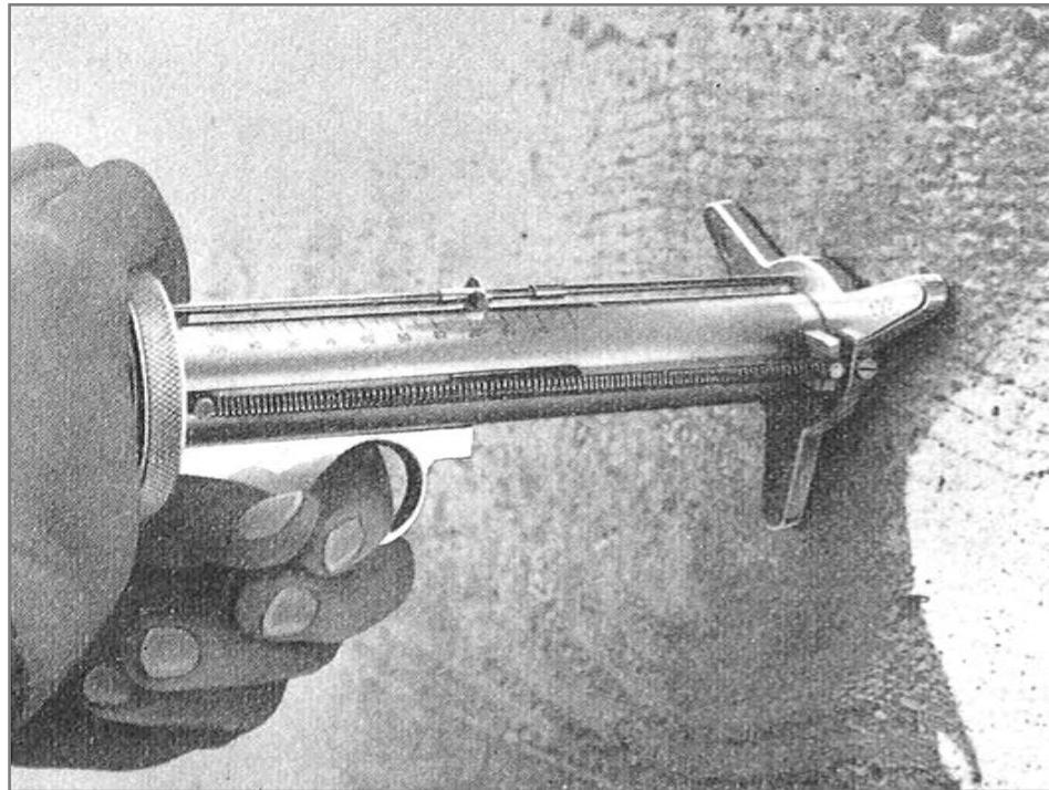
Bild 1. Der Beton-Prüfhammer im Gebrauch
