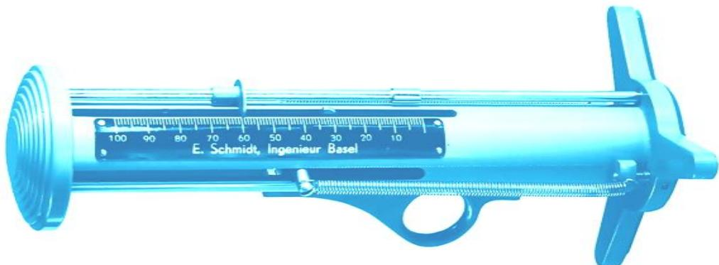
Bild: Original Schmidt Prüfhammer
