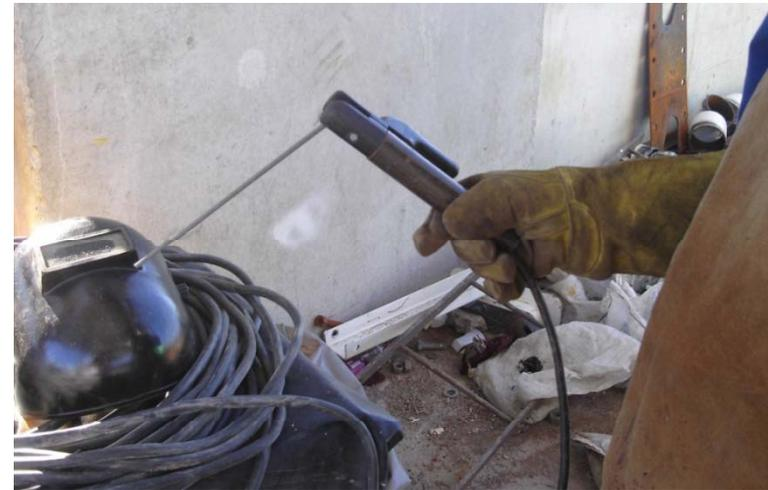
O revestimento é consumido junto com o eletrodo, transformando-se parte em gases inertes, parte em escória.
