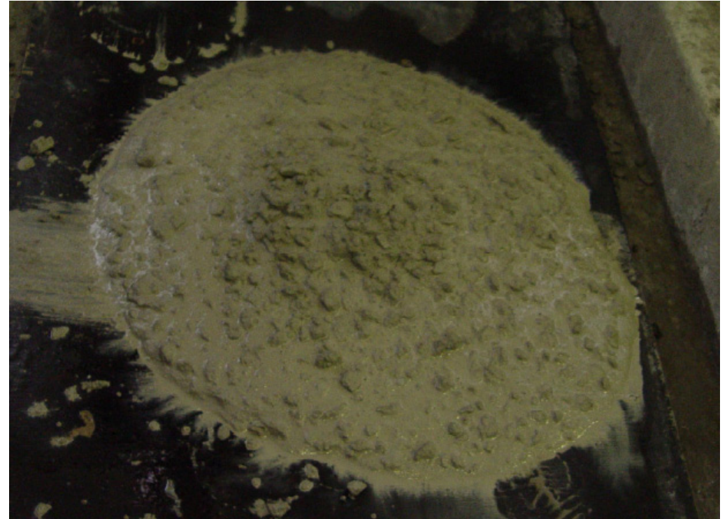
concreto fluido sem segregação
