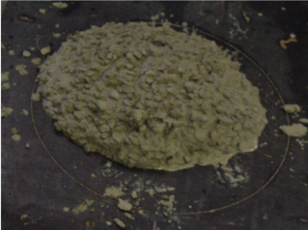
concreto pouco fluido
