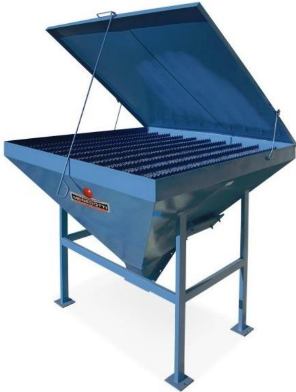
Silo de cimento “rasga saco”
