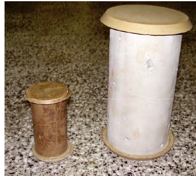
Corpo-de-prova de enxofre ao lado de um corpo-de-prova de concreto capecado
