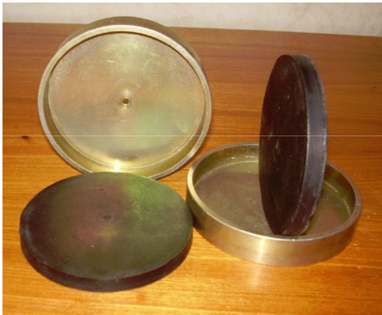
Base metálica com anel de retenção e almofadas de neoprene
