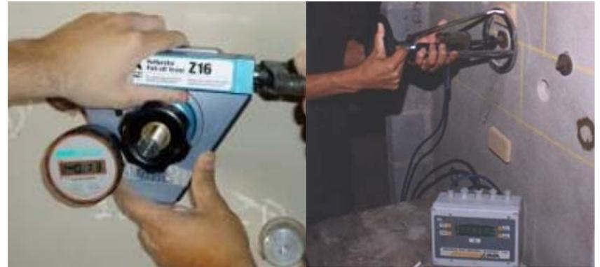
Quadro 13 c – Etapas da realização do ensaio de determinação da resistência de aderência à tração de revestimentos de argamassa, segundo a NBR 13528 (ABNT, 1995).
