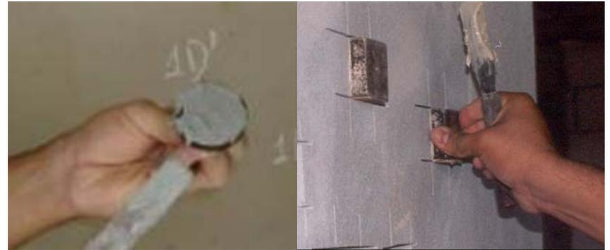
Quadro 13 b – Etapas da realização do ensaio de determinação da resistência de aderência à tração de revestimentos de argamassa, segundo a NBR 13528 (ABNT, 1995).
