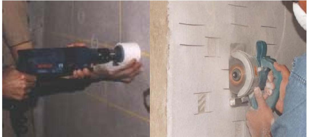
Quadro 13 a – Etapas da realização do ensaio de determinação da resistência de aderência à tração de revestimentos de argamassa, segundo a NBR 13528 (ABNT, 1995).
