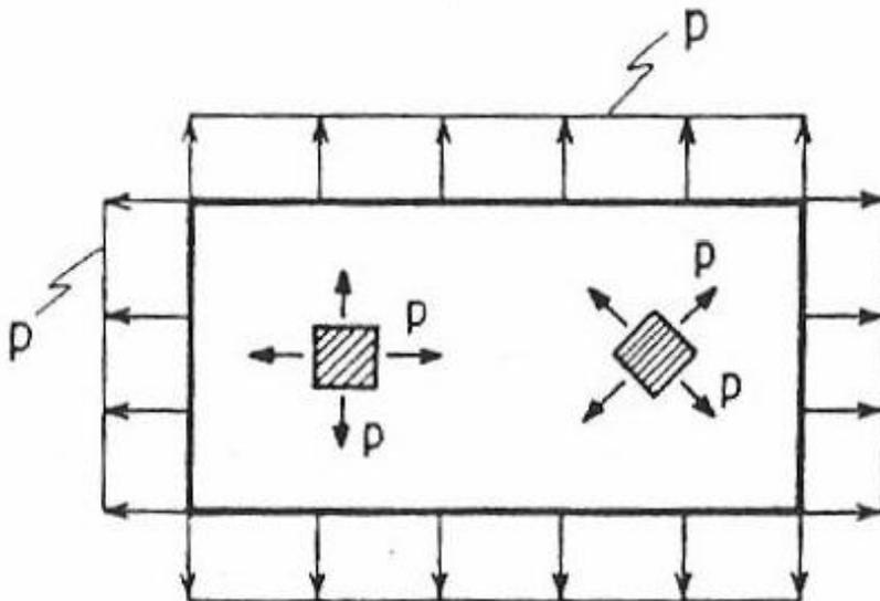
Em qualquer direção a tensão normal é  $p$  e a tensão cisalhante nula.
