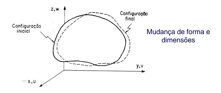
Configuração inicial indeformada ⇒ Configuração final deformada
