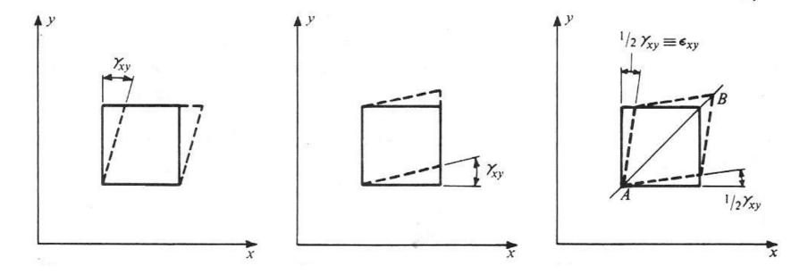
É conveniente imaginar uma rotação de corpo rígido do elemento em torno do eixo transversal de forma a se obter uma deformação angular igual sofrida por cada uma das faces transversais, com magnitude igual à metade de distorção total no plano.
