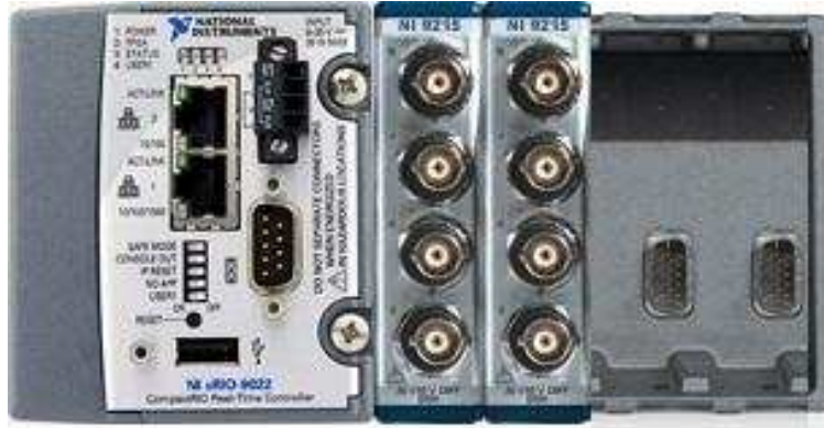
FIG. 6.2: Hardware da National Instruments (CRIO 9022, 9112 e 9234) utilizado para a implementação do sistema.
