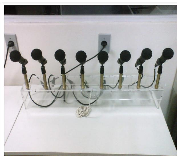
Figura 5.2: Arranjo de microfones sobre o suporte(foto)
