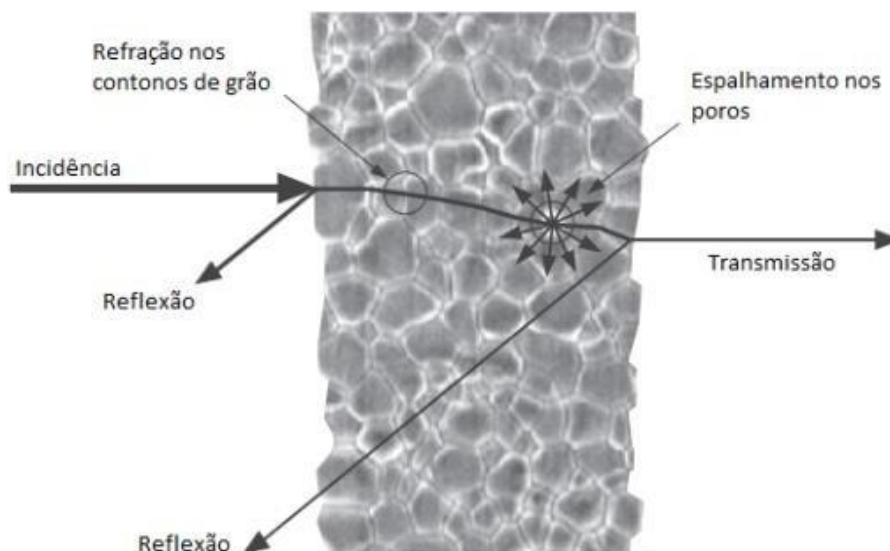
Figura 3-12: Principais mecanismos da causa de opacidade na zircônia (ZHANG, 2014).
