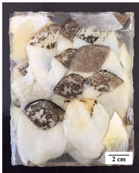
Figura 31 – Placa do material compósito com reforço de 30%v/v de escamas de pirarucu (113).
