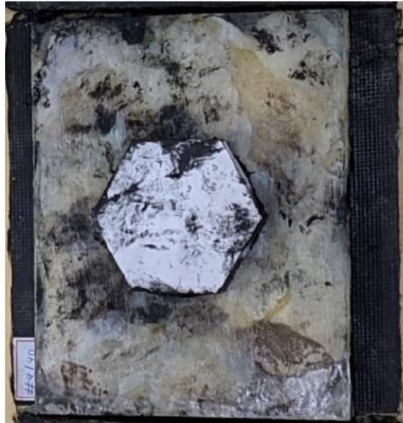
Figura 32 – Sistema de blindagem multicamada (SBM) montado usando a placa de compósito de epóxi reforçado com escamas de pirarucu como segunda camada.
