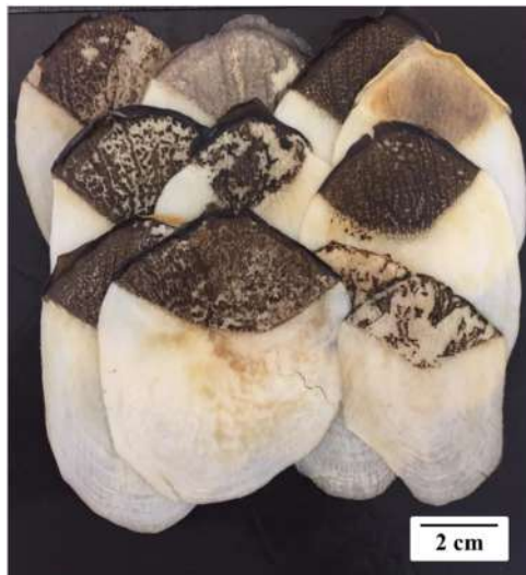
Figura 29 – Escamas de pirarucu após processo de aplanamento (113).
