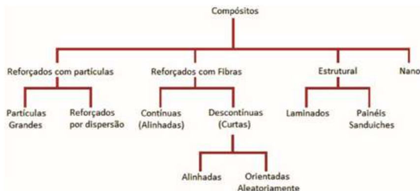
Figura 2.15 – Classificação dos compósitos quanto ao tipo de reforço (CALLISTER JR.; RETHWISCH, 2014).
