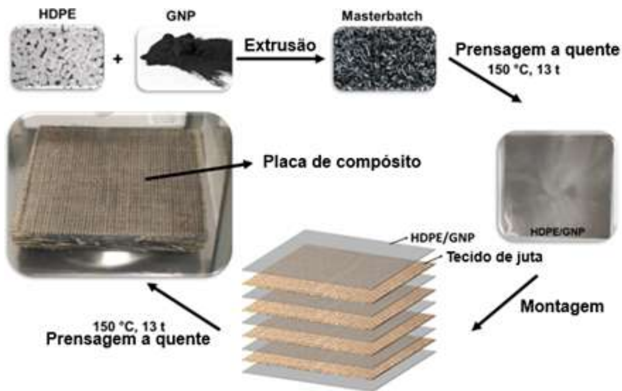
Figura 3.4 – Esquema de fabricação das placas de compósito (Autor).
