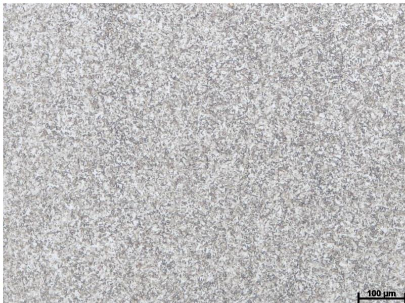
Figura 4.41: Micrografia do material de código 5. Microestrutura martensítica refinada. Ataque de Vilela. Aumento 100X.
