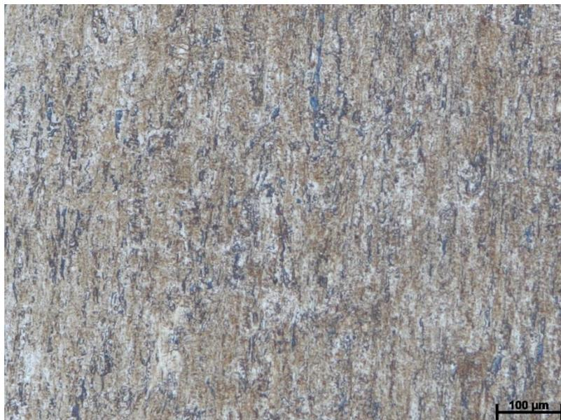
Figura 4.44: Micrografia do material de código 8. Microestrutura martensítica alongada. Ataque de Vilela. Aumento 100X.
