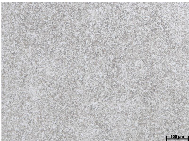
Figura 4.42: Micrografia do material de código 6. Microestrutura martensítica refinada. Ataque de Vilela. Aumento 100X.
