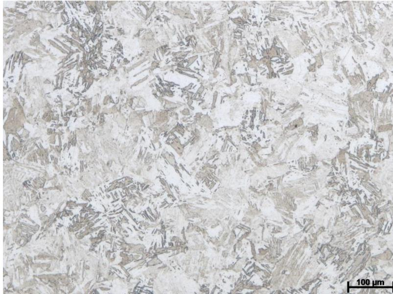
Figura 4.37: Material como recebido (código 1). Microestrutura martensítica. Ataque de Vilela. Aumento 100X.
