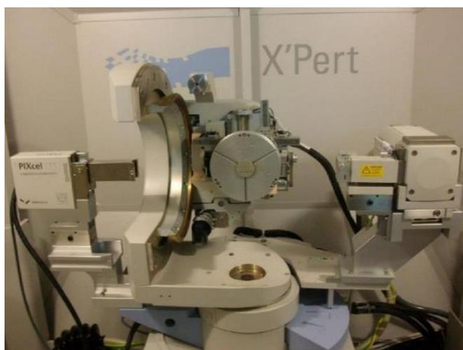
Figura 3.11: Difratorômetro de Raios-X X'PERT PRO MRD, PANalytical. Laboratório de Difração de Raios X do IME.
