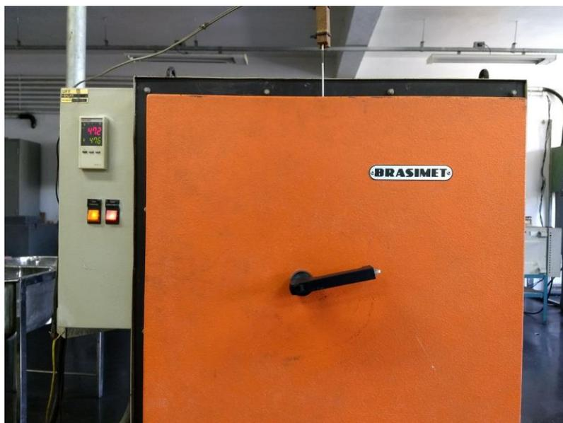
Figura 3.4: Forno Mufla Microprocessado. Laboratório de Tratamentos Térmicos da Escola de Engenharia da UFF em Volta Redonda.
