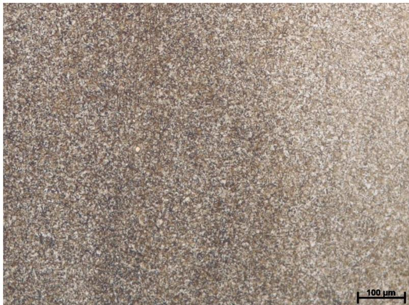
Figura 4.46: Micrografia do material de código 10. Microestrutura martensítica refinada. Ataque de Vilela. Aumento 100X.
