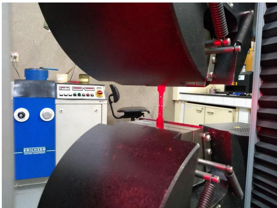
Figura 3.9: Detalhe de um corpo de prova de tração pronto para ser ensaiado.
