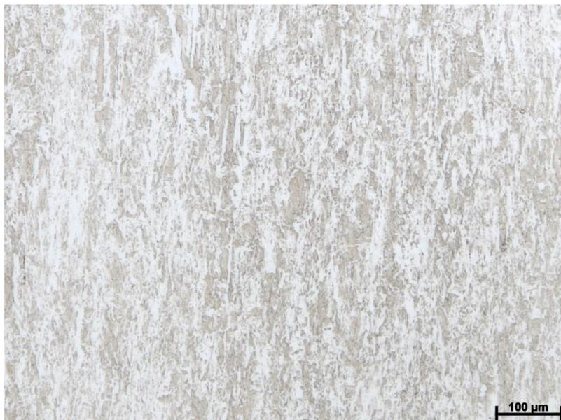
Figura 4.39: Micrografia do material de código 3. Microestrutura martensítica alongada. Ataque de Vilela. Aumento 100X.
