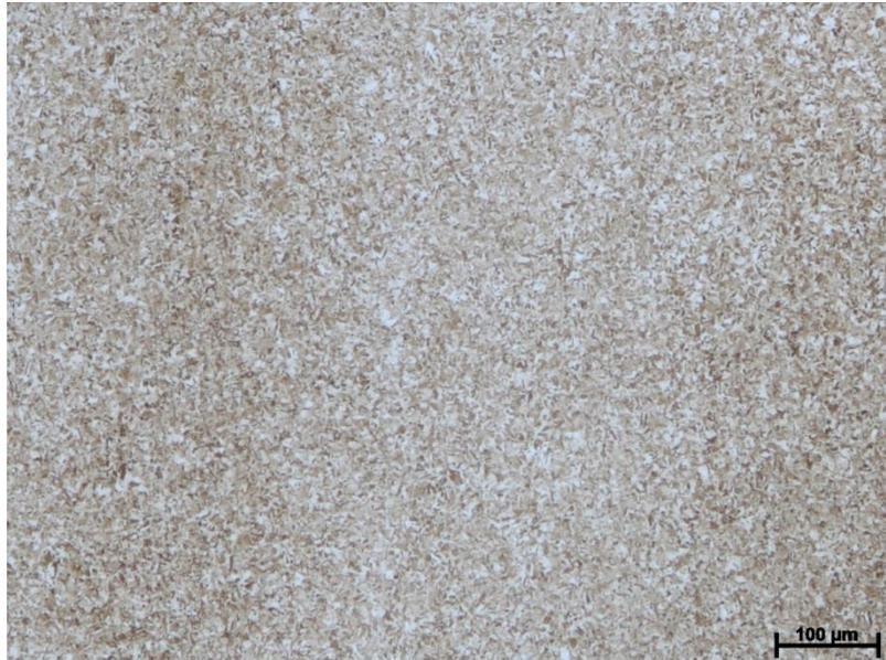
Figura 4.45: Micrografia do material de código 9. Microestrutura martensítica refinada. Ataque de Vilela. Aumento 100X.
