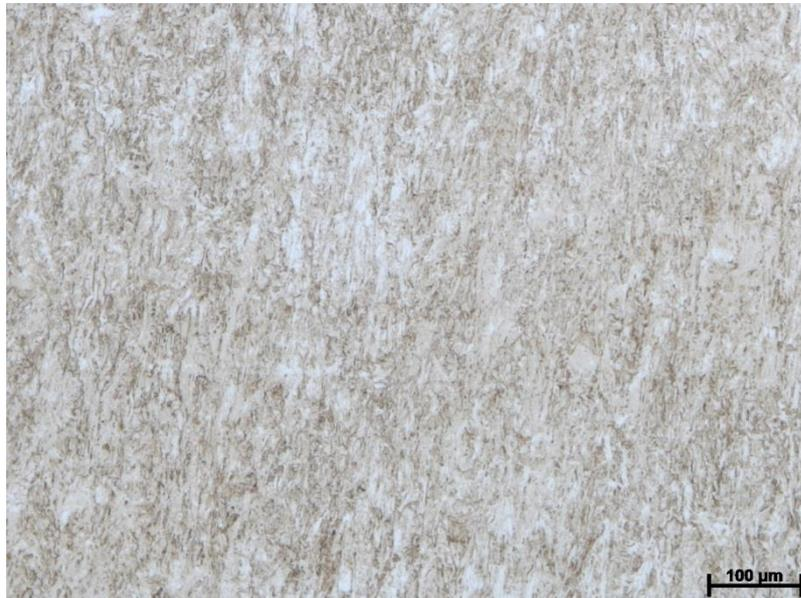
Figura 4.43: Micrografia do material de código 7. Microestrutura martensítica alongada. Ataque de Vilela. Aumento 100X.
