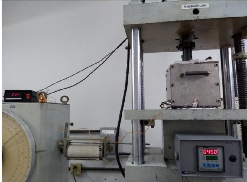
FIG. 4.4: Aparato montado para o processo de deformação plástica severa via ECAP.
