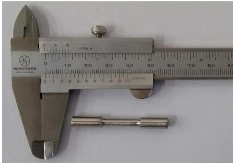
FIG. 4.9: Corpo de prova de seção cilíndrica reduzido para ensaio de tração.
