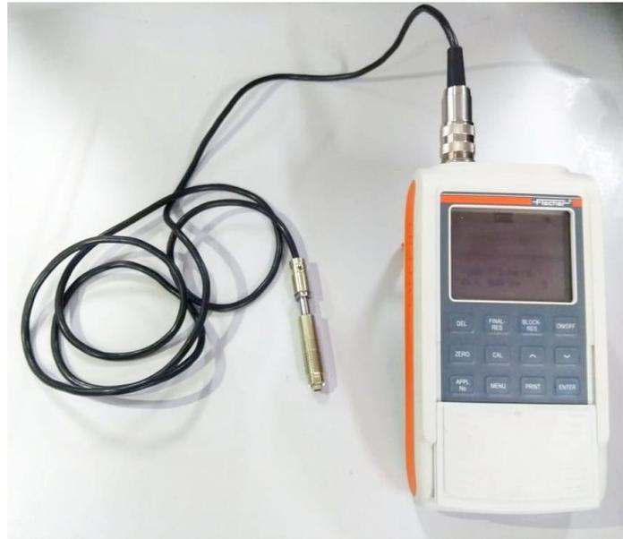
FIG. 4.12: Ferritoscópio.
