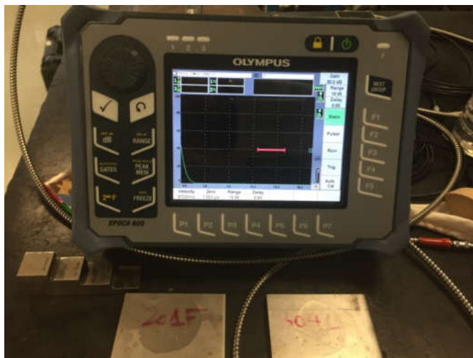
Figura 3.7 – Ultra-som Epoch 600 da Olympus utilizado para a determinação das propriedades elásticas dos aços inoxidáveis ASTM 201LN e 304L.
