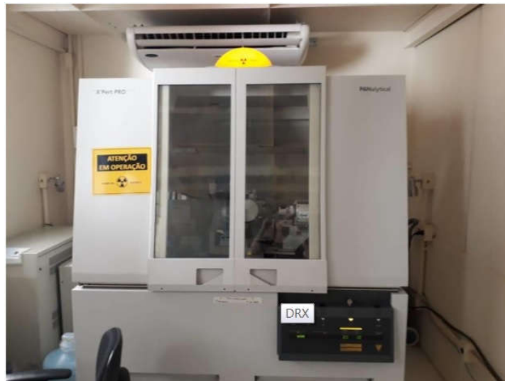
Figura 3.15 - Difratorômetro de Raios X, modelo X'PERT PRO MRD da PANalytical.
