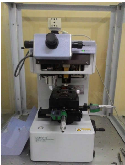
Figura 3–13 - Ultramicrodurômetro instrumentado, marca Shimadzu, modelo DUH-211S.
