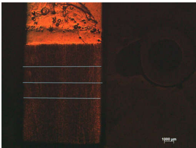
Figura 3.14 – Corte transversal da amostra em forma de disco, após ensaio em barra Hopkinson. Observa-se a identificação da face de impacto a direita na imagem, por meio de objeto circular e três linhas brancas que indicam a medição de ultramicrodureza.
