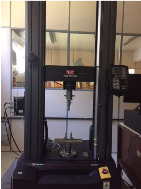
Figura 3.23 – Máquina universal de ensaios Instron modelo 5969 instalada no CTEEx.
