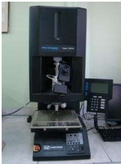
Figura 3.9 - Microdurômetro Instron Tukon 2100-B com indentador Vickers acoplado.
