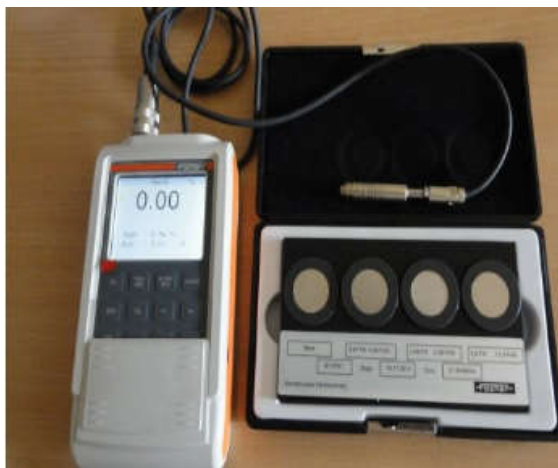
Figura 3.19 – Ferritoscópio FISHER - FMP30 e as amostras padrões para calibração
