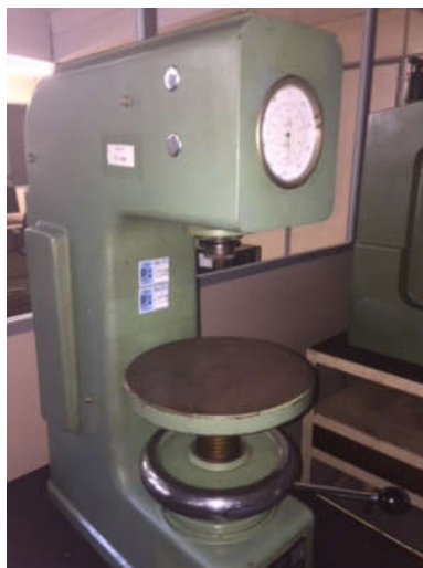
Figura 3-8 – Durômetro WOLPERT para as medidas na escala Rockwell instalado no CTEEx
