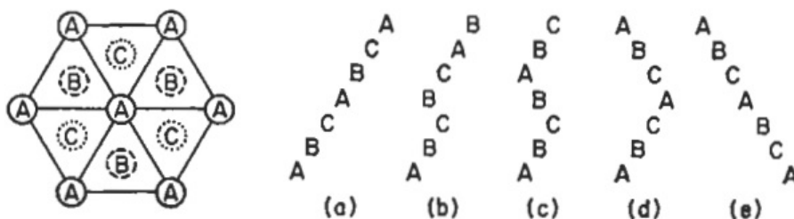
Figura 2.12 – Vista planar das posições atômicas e sequências de empilhamento para: (a) cristal CFC perfeito; (b) falha intrínseca; (c) falha extrínseca; (d) falha de macla; (e) cristal de macla. (CAHN, HAAASEN, 1996).
