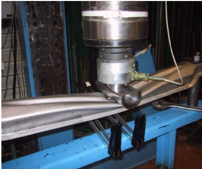
Figura - 1.2 Dispositivo para ensaio de flexão (ANDERSSON; OCKLUND; PERSSON; 2010).
