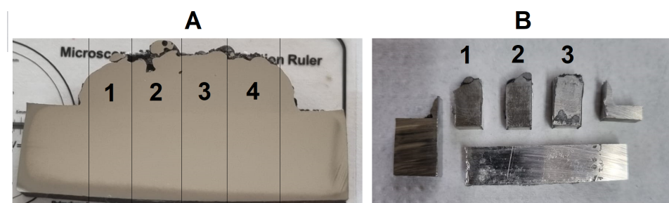
Figura 64 – Fotografias da amostra V4 (12 camadas) depositadas por MA: (A) corte transversal após a fabricação com ilustração das posições de seccionamento; (B) segmentação em porções para realização de tratamentos térmicos evidenciando as amostras utilizadas nas condições temperada, temperada e revenida uma vez e temperada e revenida duas vezes.
