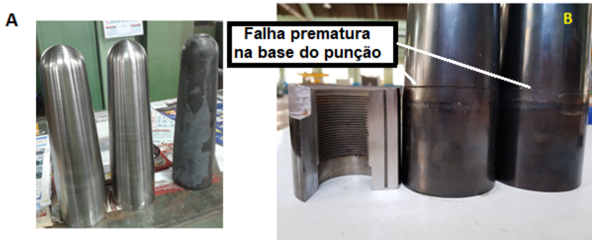
Figura 2 – Fotografias de (A) dois punções (esquerda e centro) após usinagem inicial na ferramentaria e um escurecido (direita) imediatamente após ser submetido a tratamentos térmicos sem atmosfera protetiva (restando ser finalizado para chegar às dimensões finais desejadas); (B) exemplares de punções que apresentaram falha prematura.
