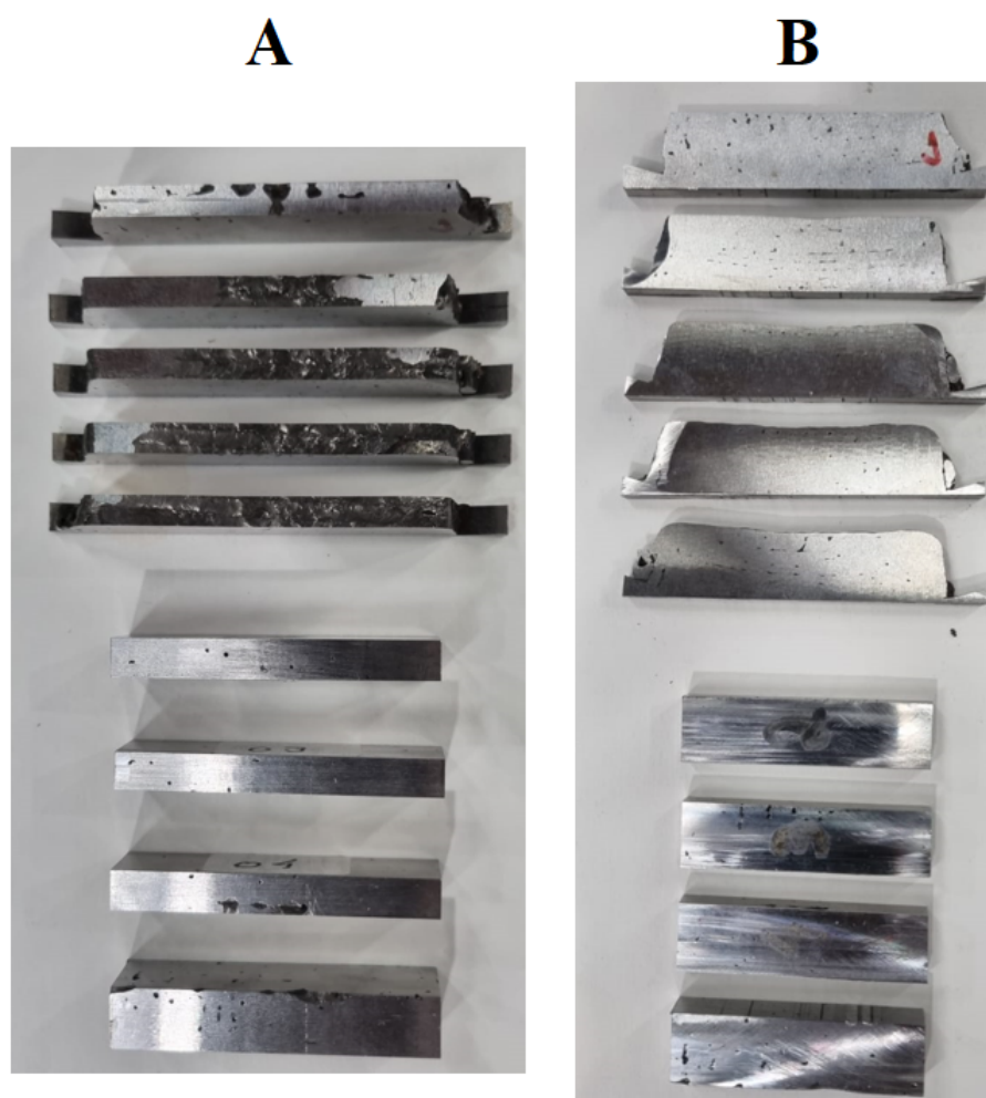
Figura 167 – Fotografias do seccionamento realizado no bloco para geração de CP para ensaio Charpy. (A) Vista de topo; (B) Vista lateral.
