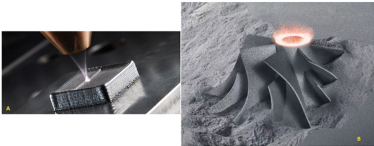
Figura 3 – (A) Exemplo de laser cladding , aplicação da tecnologia de deposição por energia direcionada (L-DED); (B) Exemplo de peça fabricada pela tecnologia de fusão em leito de pó ( Powder Bed Fusion - PBF (32)), também conhecida como Fusão Seletiva a Laser (FSL).
