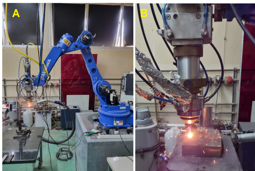
Figura 58 – Visão Geral do Equipamento de Deposição MA/DED do IEAv:(A) Braço Robótico; e (B) Cabeçote com laser e alimentadores de pó.
