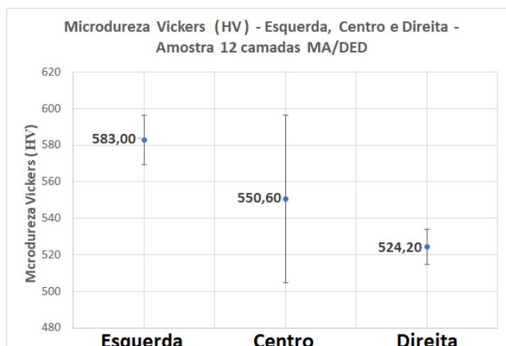
Figura 144 – Resultados de microdureza Vickers (HV) para as posições A) à esquerda; B) ao centro; e C) à direita, em referência à Figura 140, B.
