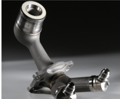
Figura 4 – Bico de combustível da General Electric - GE . Caso de sucesso ao reunir em peça única produzida por MA o que antes era obtido com a junção de 20 peças diferentes e ainda reduzindo peso. Em 2018 a empresa comemorou a marca de 30.000 destas peças produzidas em sua planta no Alabama (33).
