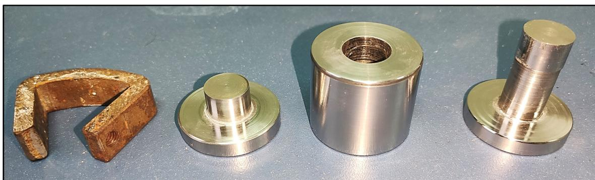
Figura 3.3 – Matriz cilíndrica utilizada na preparação das amostras.
