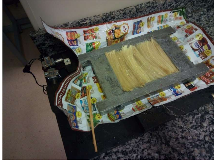
Figura 4.6 Molde em utilização para confecção de placas de compósitos.
