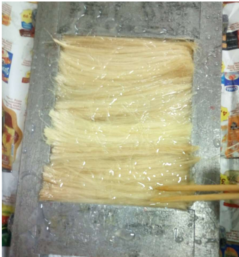
Figura 5.9 Fibras de curauá sendo alinhadas dentro do molde enquanto a mesa vibratória faz a remoção de gases do interior do polímero.
