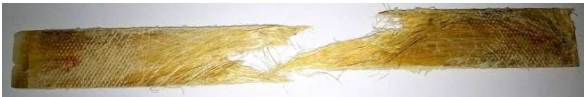
Figura 5.14 Aspecto macroscópico da fratura dos compósitos reforçados com 80% em fração volumétrica de fibras de curauá.
