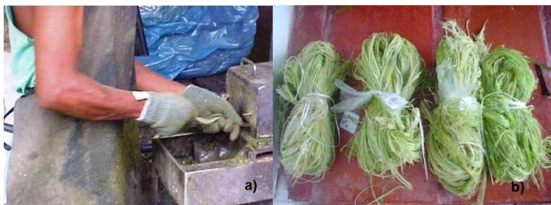
Figura 3.12 Processo de moagem (a) e as fibras processadas (b)
