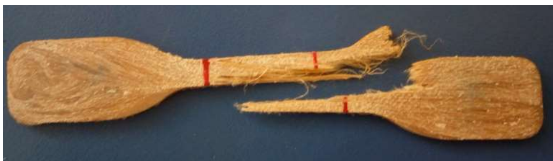
Figura 5.7 Aspecto macroscópico da fratura dos corpos de prova reforçados com 80% em fração volumétrica de fibras finas de curauá.
