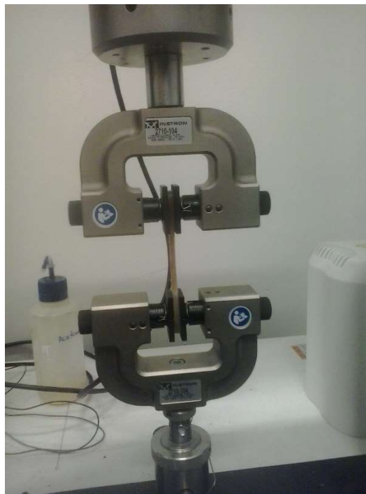
Figura 4.7 Corpo de prova preso à máquina pronto para o ensaio.
