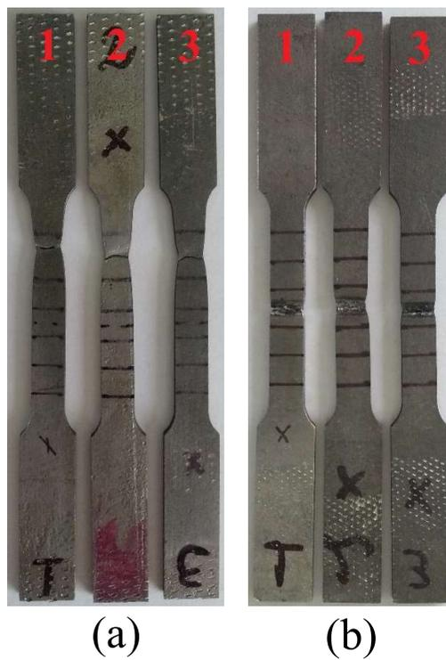
Figura 12 - CPs de tração após a ruptura das amostras: (a) 2RR e (b) D-2RR-S2.
