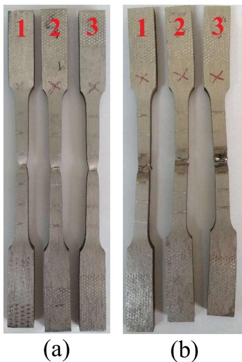
Figura 11 - CPs de tração após a ruptura das amostras: (a) 1RR e (b) D-1RR-S2.
