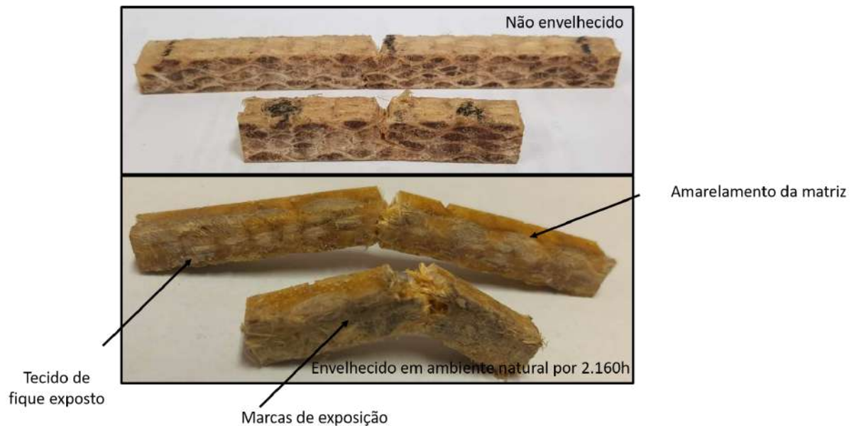
Figura 158 – Amostras de Charpy e Izod antes e após o envelhecimento natural por 2160h.
