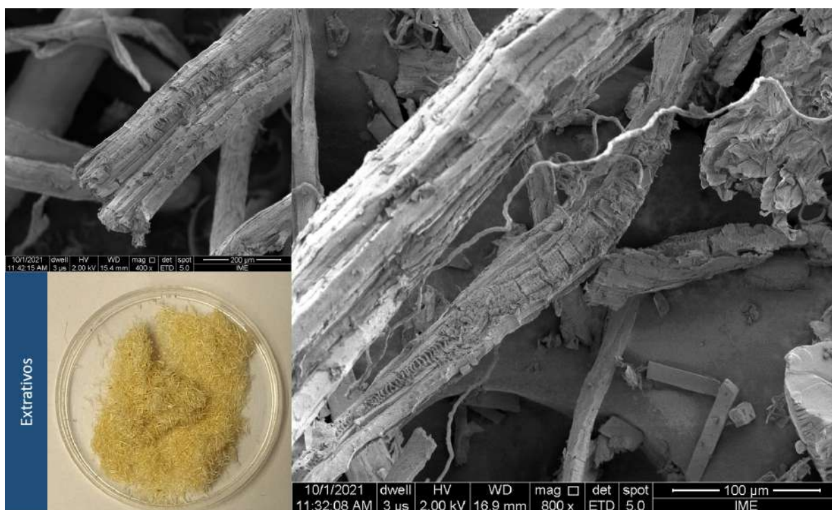
Figura 24 – Microestrutura da fibra de fique após retirada dos extrativos.
