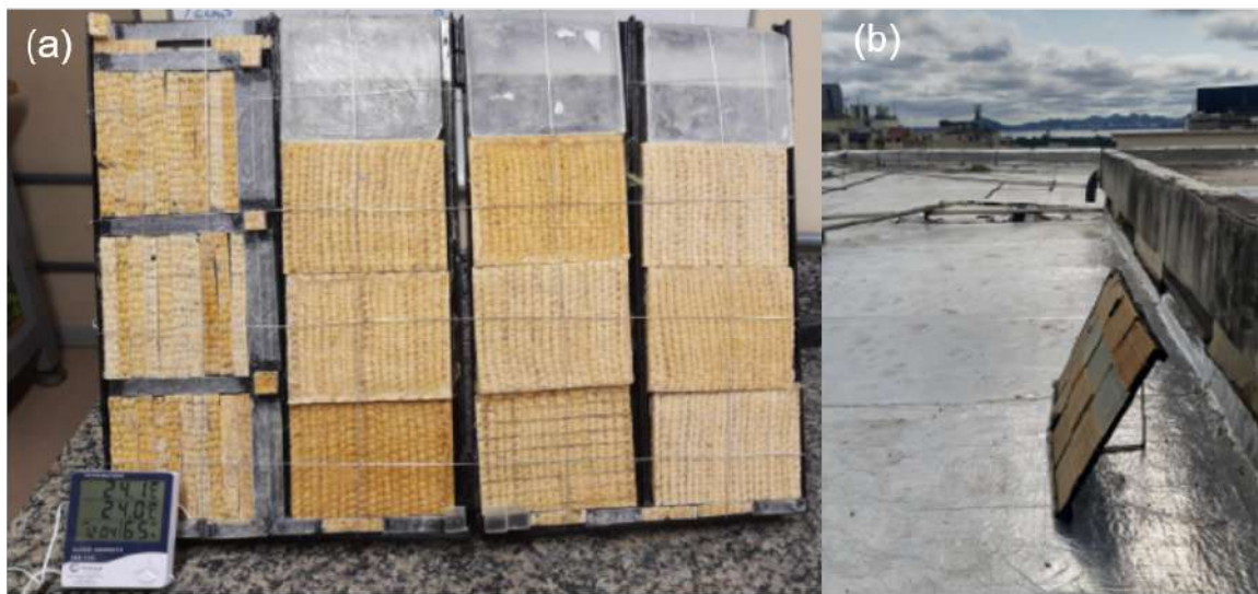
Figura 19 – Aspecto geral do ambiente de envelhecimento natural (a) vista frontal e (b) lateral.
