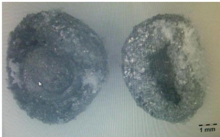
**FIG.4.23 Deformação nos projéteis após impacto balístico nas amostras ACB 80 e ACB 85, respectivamente**
