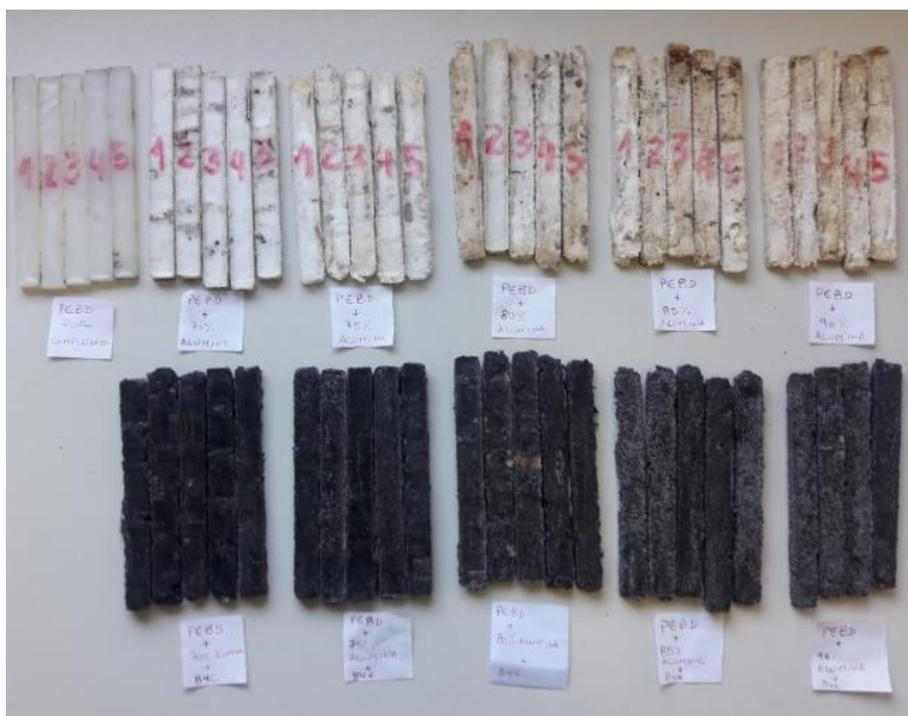
**FIG. 3.10 Grupo de materiais separados para o ensaio de flamabilidade**
