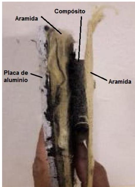
**FIG. 3.21** Corpo de prova usado no ensaio balístico com projéteis 7,62 mm
