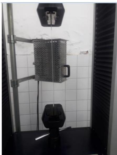
FIG. 3.12 Corpo de prova sendo tracionado na máquina de ensaios
