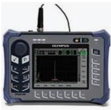
**FIG. 3.14** Aparelho usado nas medições ultrassônicas
