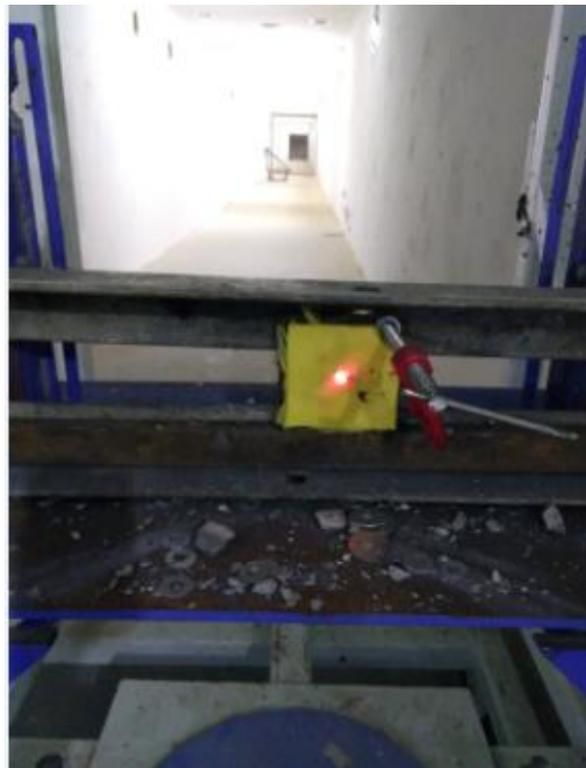
**FIG.3.22** Conjunto submetido ao ensaio balístico com projéteis 7,62mm no CAEx
