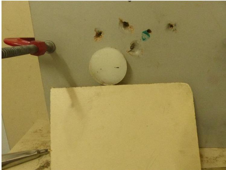
**FIG.3.18** Corpo de prova apoiado numa placa de MDF antes do ensaio balístico
