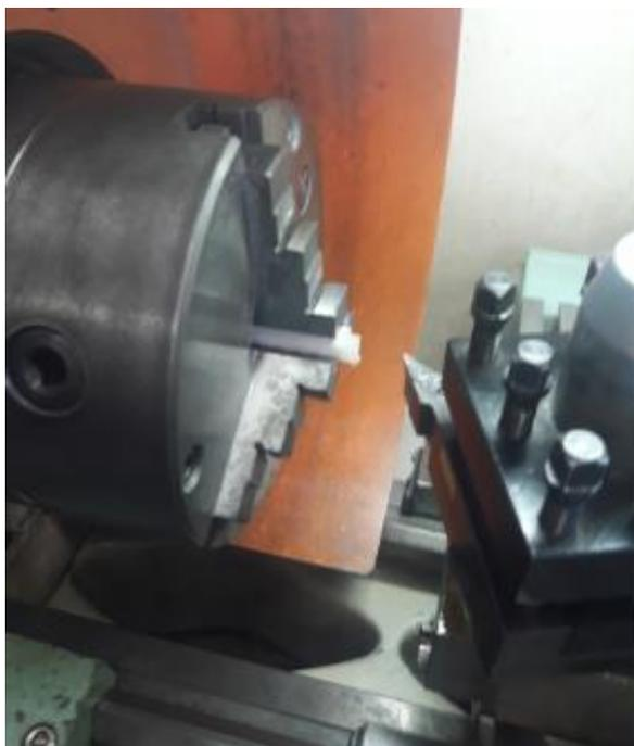
**FIG. 3.9** Corpos de prova para ensaio de compressão usinados no torno mecânico
