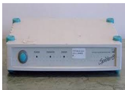
(b) Sistema de aquisição de dados - Spider 8.
