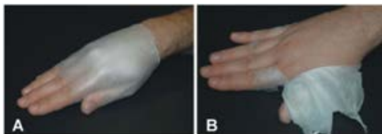
Figura 20 – Fotografias apresentando a pulverização das nanofibras diretamente em tecido vivo: a) Tapete de PLA não tecido que reveste uma mão e b) remoção parcial do revestimento (12).
