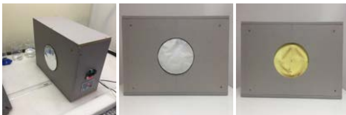
Figura 40 – Fotografia do alvo de deposição de disco com controle de temperatura e velocidade desenvolvido.
