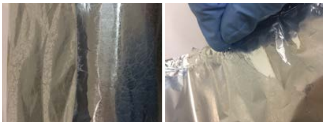
Figura 30 – Aspecto macroscópico da fiação do PEUAPM durante a fase de testes de parâmetros realizados. Fonte: Autor.
