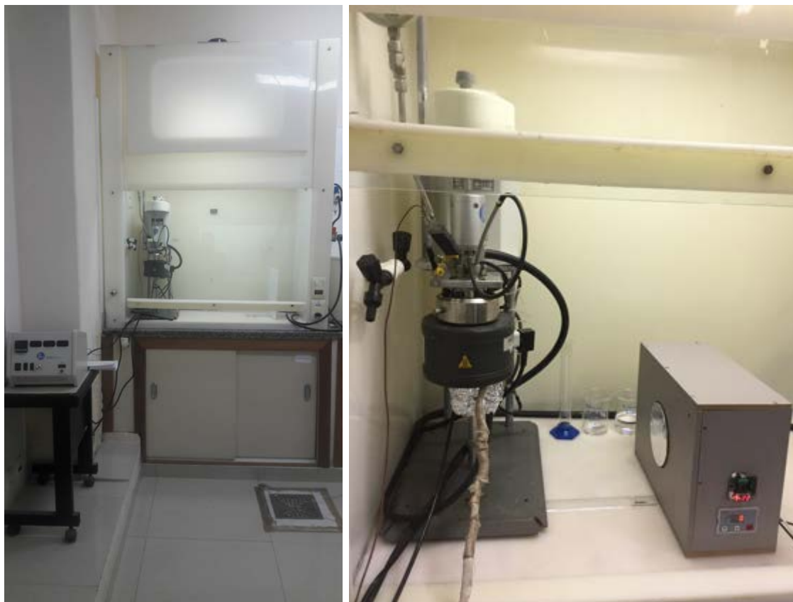
Figura 38 – Fotografia do equipamento de solution blow spinning montando e com alvo de deposição posicionado.
