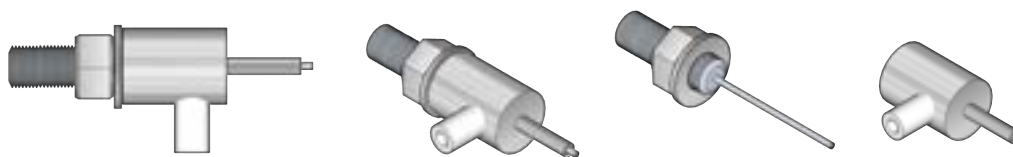
Figura 27 – Modelagem 3D do bico de injeção intercambiável desenvolvido. Fonte: Autor.
