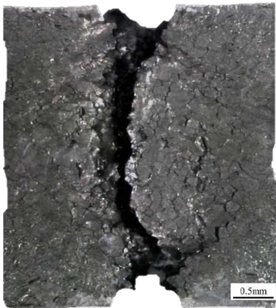
Figura 4.17 – Superfície lateral da fratura, aço Mod-310, após ensaio de fluência em 675°C, 300MPa, t_f=237,3 hr.
