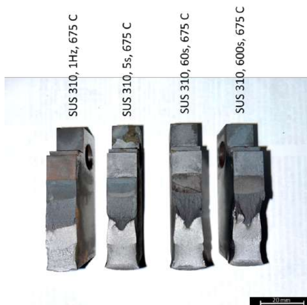
Figura 4.29 – Superfície de fratura após fluência-fadiga, aço Mod-310, da esquerda para a direita: 0 s, 5 s, 60 s e 600 s.
