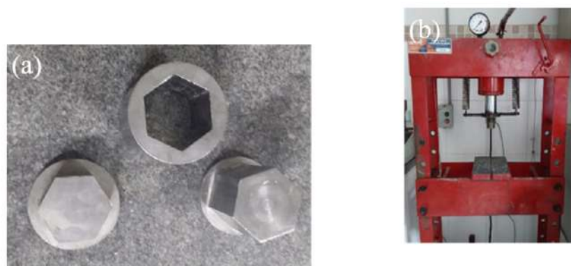
Figura 28 – (a) Conjunto pistão-matriz camisa flutuante. (b) Prensa manual SKAY.
