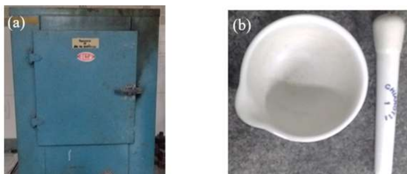
Figura 26 – (a) Estufa da marca ELKA. (b) Almofariz e pistilo.
