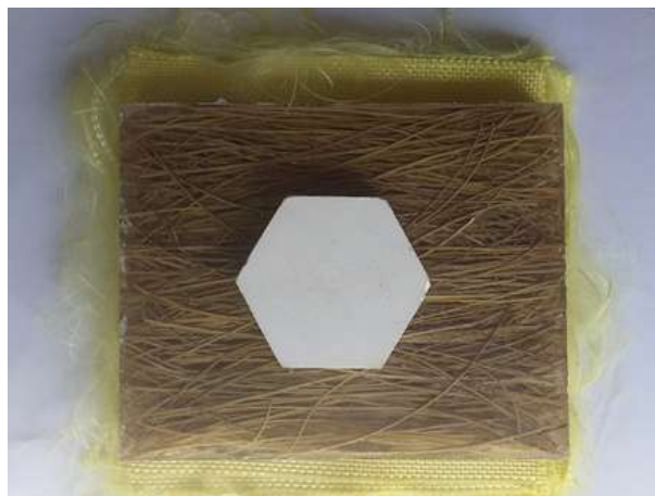
Figura 30 – Sistema de Blindagem Multicamadas (SBMs) montado.
