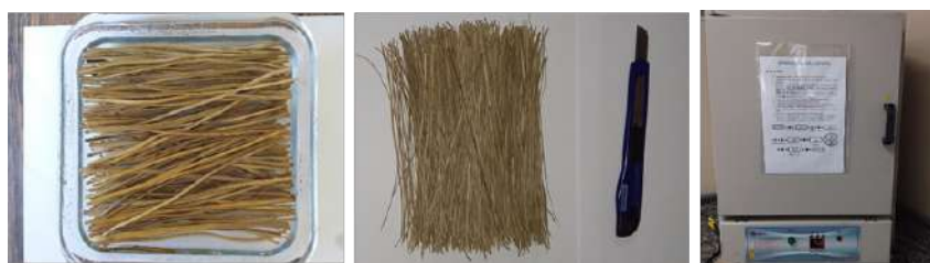
Figura 19 – Processo de extração das fibras de cipó-titica; (a) umedecimento das fibras; (b) extração das fibras e secagem natural; (c) secagem em estufa.
