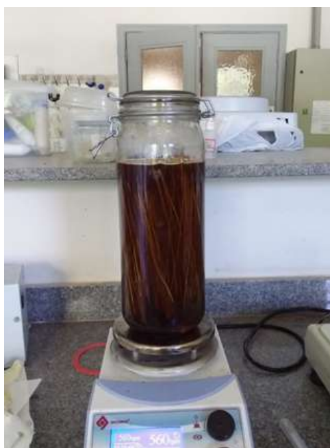
Figura 24 – Tratamento das fibras sob aquecimento e agitação magnética com CaLS 5%.
