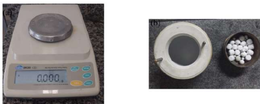
Figura 25 – (a) Balança de precisão GEHAKA, modelo BK300. (b) Moinho de bolas de Alumina, modelo MA-500 e bolas de moagem de alumina.
