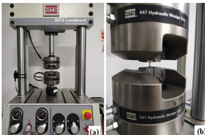
Figura 31 – Máquina de fadiga servo hidráulica MTS Landmark, com capacidade de 35 kN
