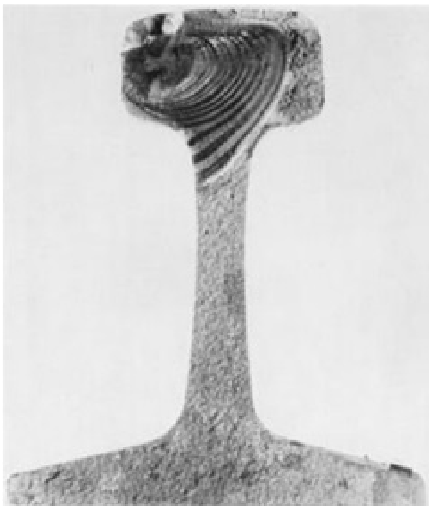
Figura 11 – Macrografia da fratura de um trilho de trem que falhou por fadiga.
