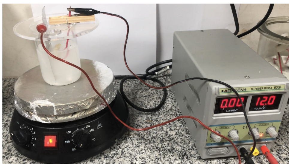
Figura 18 – Sistema de deposição do Nióbia.
