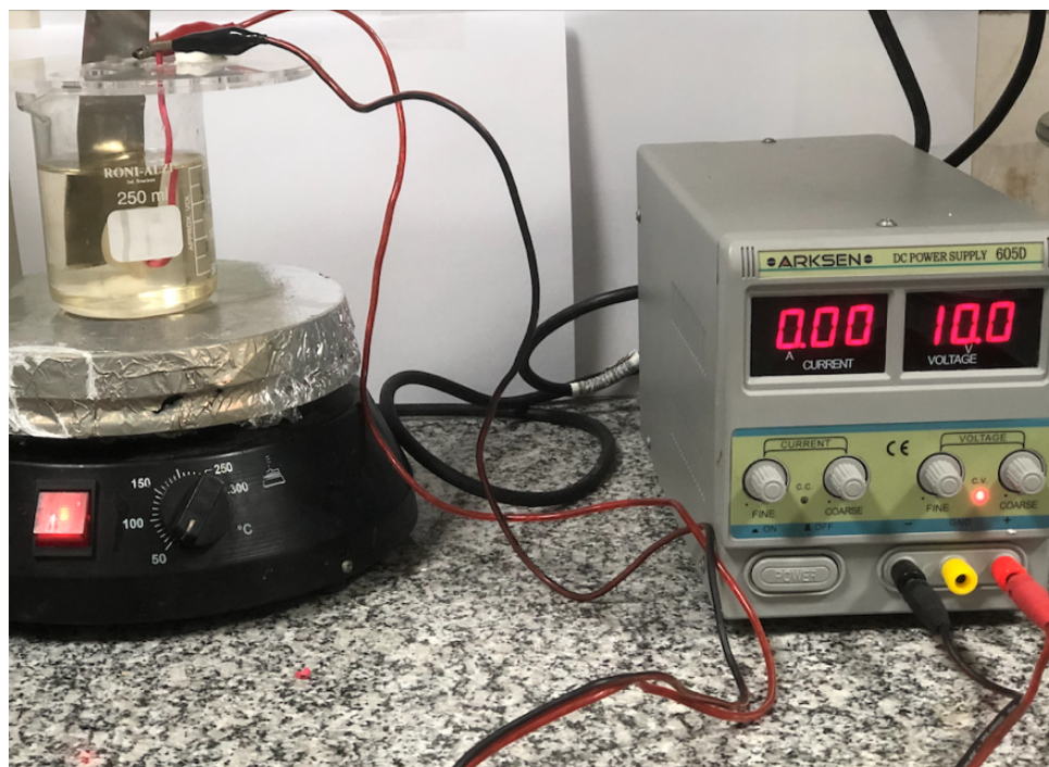
Figura 17 – Sistema de deposição do GO.
