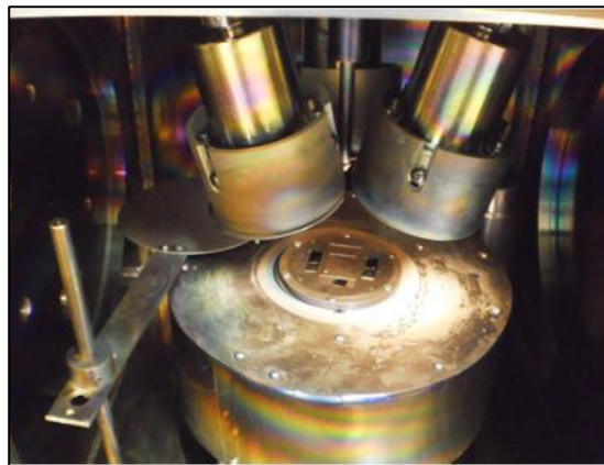
FIG. 5.2 – Interior do equipamento de pulverização catódica
