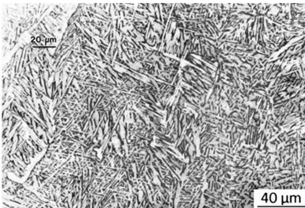
FIG. 3.10 - Microestrutura \alpha e \alpha' martensítica, com padrão de Widmanstätten obtido no processo EBM ( W.S.W. HARUN et al. , 2018).
