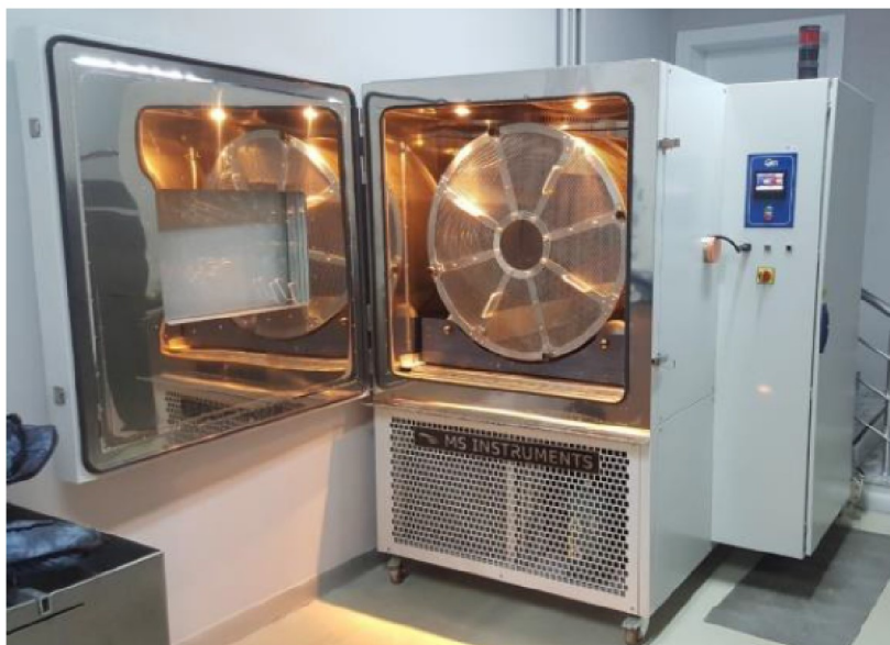
Figura 2.12 – Equipamento Tumbler utilizado na avaliação de coletes balísticos pela NIJ 0101.06.
