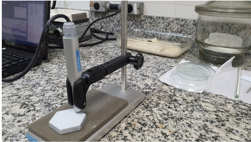
Figura 3.11 – Equipamento utilizado para a realização do ensaio de excitação por impulso.
