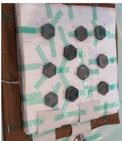
Figura 3.8 – Montagem do SBM utilizados nos testes balísticos.
