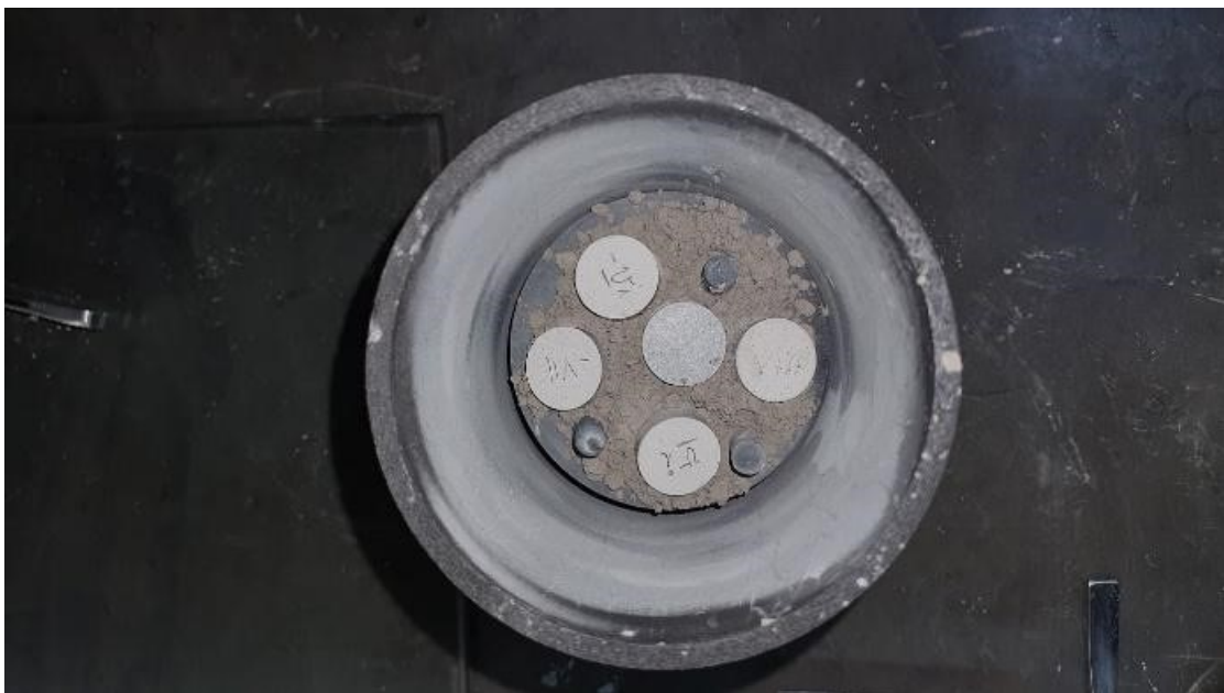
Figura 3.7 – Amostras dispostas sobre o leito de SiC no cadinho de grafite.
