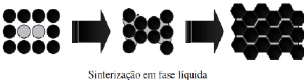
Figura 2.34 – Sinterização com presença de fase líquida.
