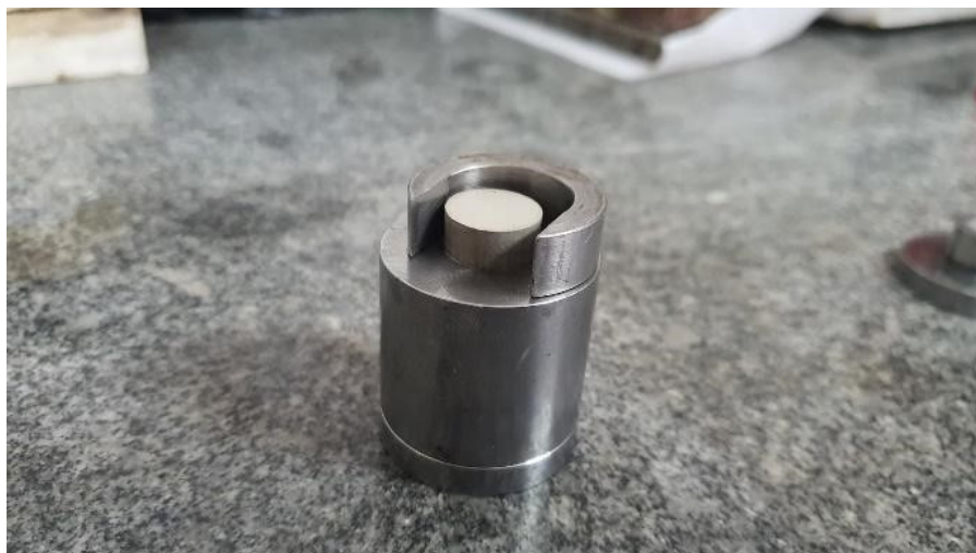
Figura 3.2 – Matriz cilíndrica com 15 mm de diâmetro.
