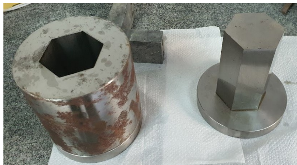
Figura 3.3 – Matriz de seção reta hexagonal.
