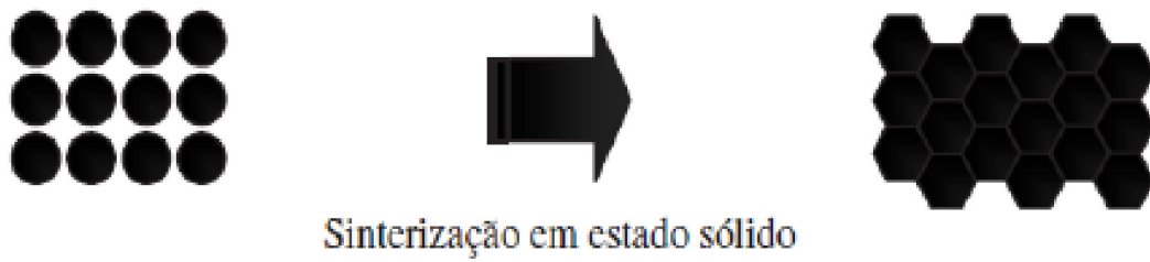
Figura 2.32 – Sinterização em estado sólido.
