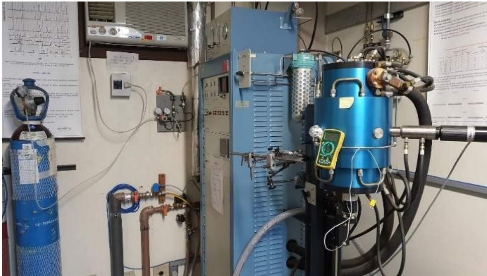
Figura 3.6 – Forno com elemento aquecedor de grafite e atmosfera de Ar.
