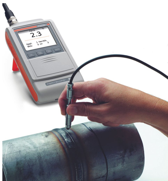
Figura 37 – Ferritoscópio sendo utilizado em uma junta soldada.
