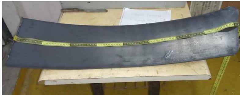
Figura 20 – Chapa de aço maraging C18Ni1700 usado na pesquisa.
