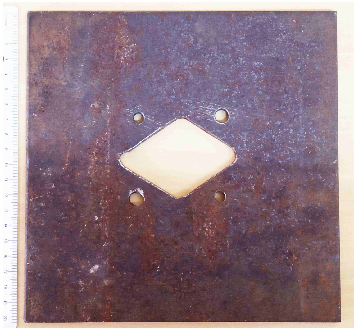
Figura 118 – Chapa contendo orifício em forma de losango e furos para fixação dos alvos.
