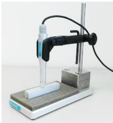
Figura 33 – Exemplo de transdutor utilizado na técnica de excitação por impulso (275).
