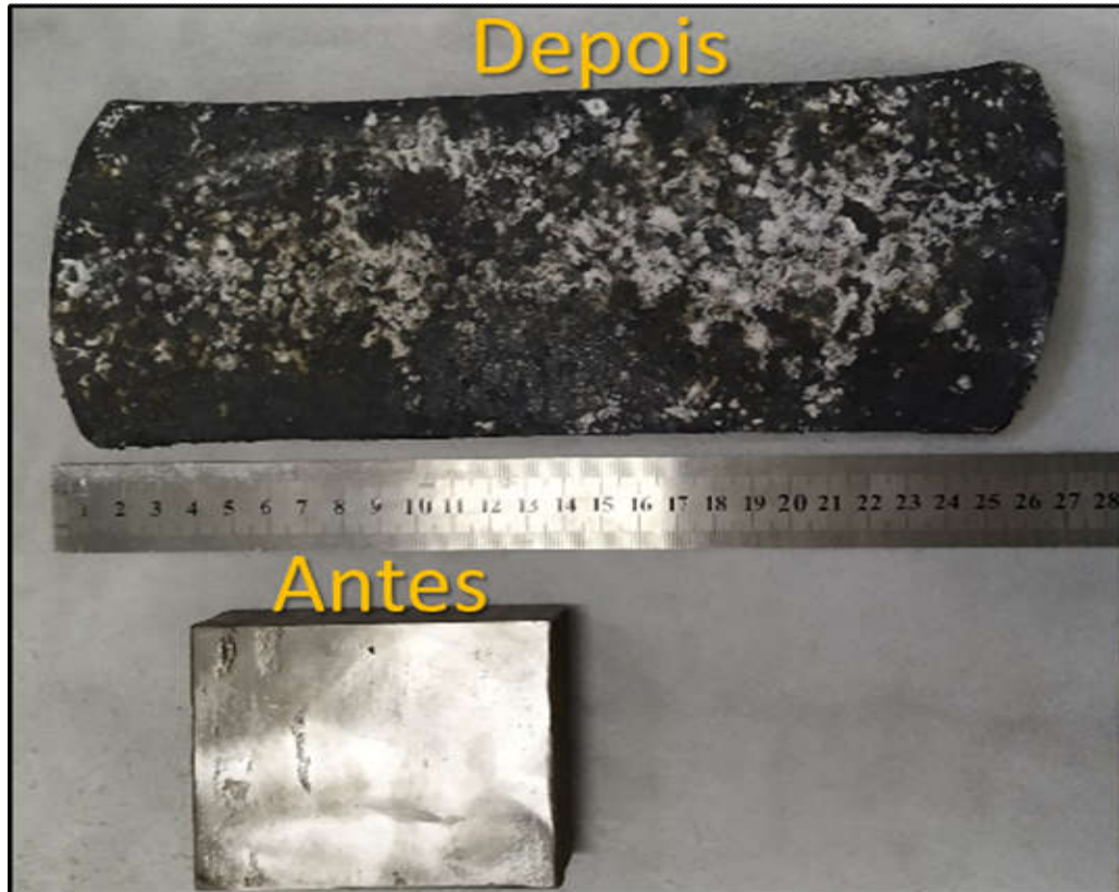
FIG 54 Aspecto das amostras antes (inferior) e depois (superior) da laminação a quente.
