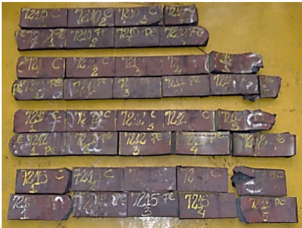
FIG 53 Barras cortadas e identificadas após laminação de desbaste.
