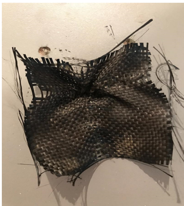
Figura 56 – Amostra F55 após impacto balístico.
