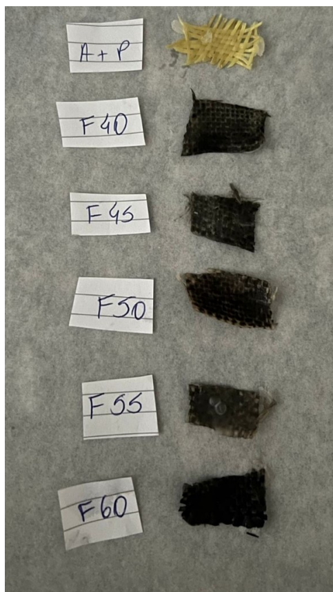
Figura 27 – Compósitos impregnados com parafina.
