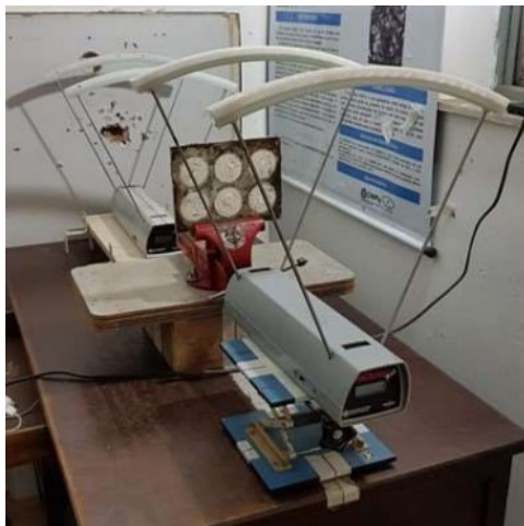
Figura 30 – Imagem do sistema de detecção no ensaio de energia de absorção.
