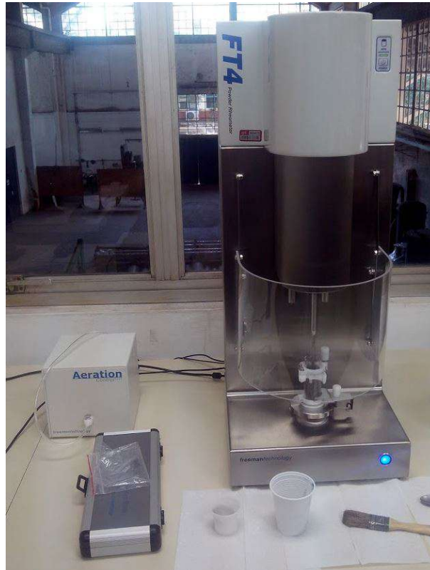
Figura 50 – Condução do ensaio no reômetro FT4 Freeman.
