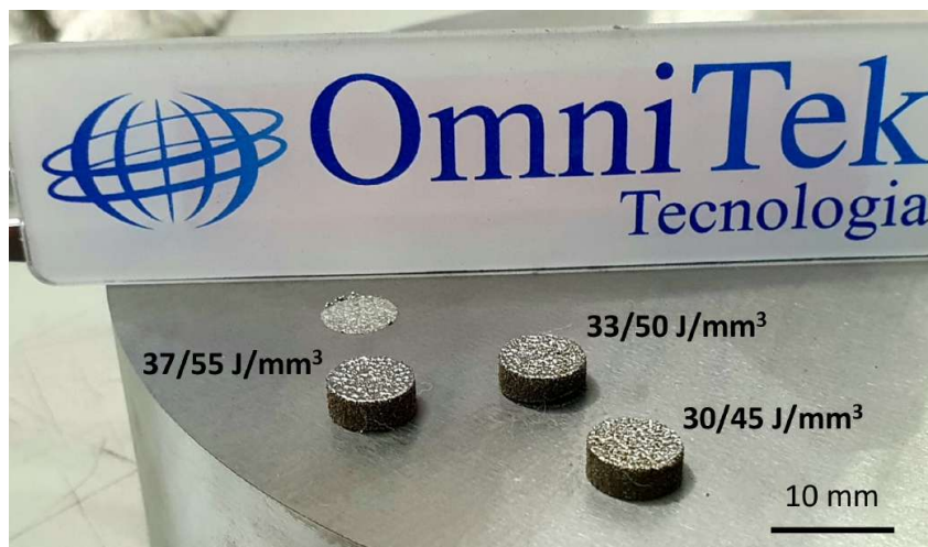
Figura 101 – Fotografia das amostras do Lote 2 na plataforma de construção.
