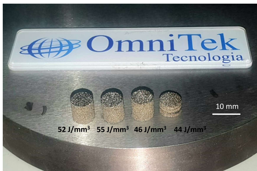
Figura 100 – Fotografia das amostras do Lote 1 na plataforma de construção.
