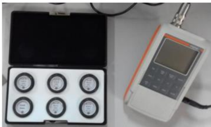
Figura 3-5: Ferritoscópio FISCHER - FMP30, para a quantificação de martensita deste estudo (Adaptado de ALVES, 2018).
