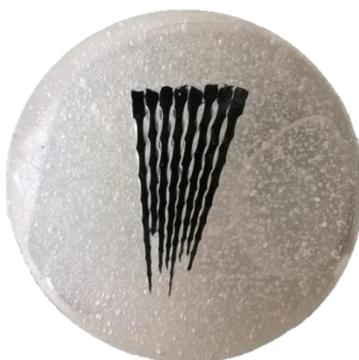
**FIG. 4.13** Instrumentos endodôntico Protaper Universal embutidos e preparados antes da etapa de revelação da microestrutura
