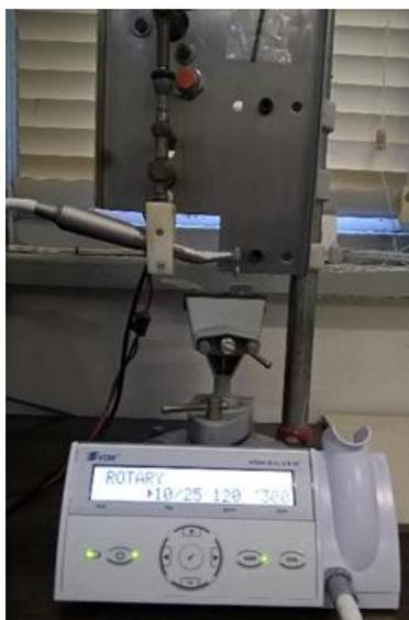
**FIG. 4.6** Dispositivo desenvolvido para o ensaio de fadiga por flexão rotativa
