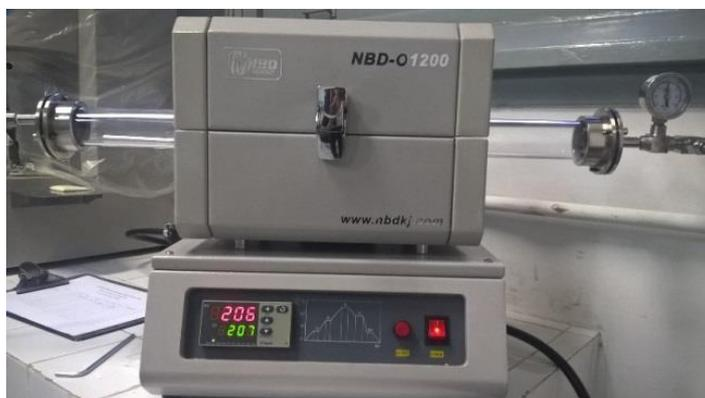
**FIG. 4.3** Forno NBD-O1200 utilizado para os tratamentos térmicos
