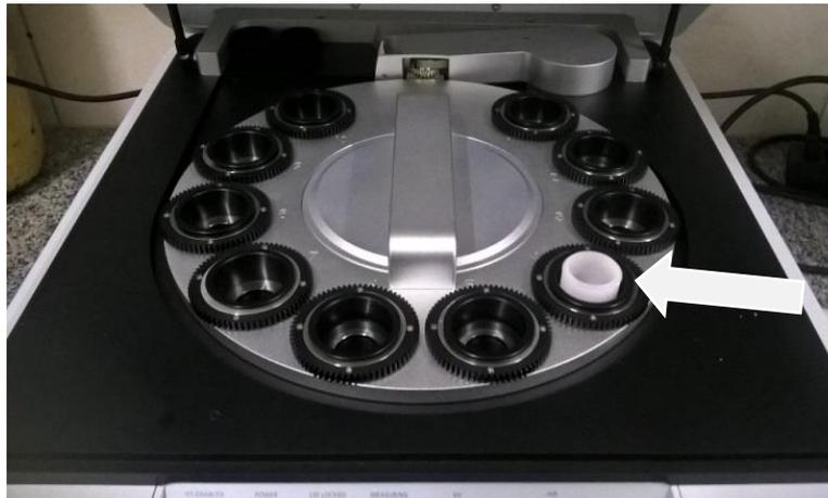
**FIG. 4.11** Espectrômetro Epsilon 3 XLE, indicando a posição da amostra no interior do aparelho
